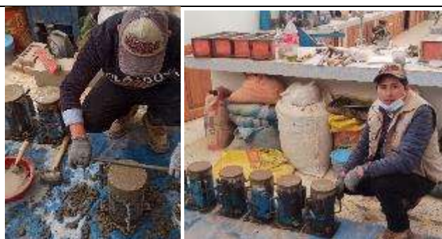
Fotografía 21: Elaboración de brobetas cilíndricas para ensayos a compresión para edad de 7 días
