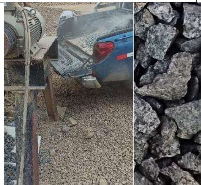
Fotografía 06: Carguío de material – roca sienita triturada – Forma angular, textura rugosa cristalina
