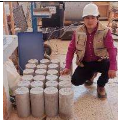
Fotografía 28: Probetas cilíndricas para ensayos a tracción a los 14 y 28 días
