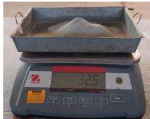
Fotografía 12: Material que pasa la malla N° 200 para ensayos laboratorio Quimica UNA - PUNO
