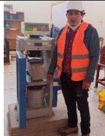
Fotografía 26: Rotura de probetas a flexión – sustitución al 100% sienita como agregado grueso
