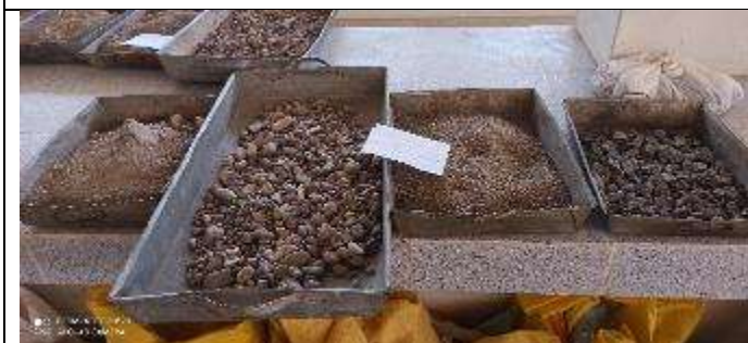
Fotografía 17: Dosificación de componentes del C°/ Probeta
