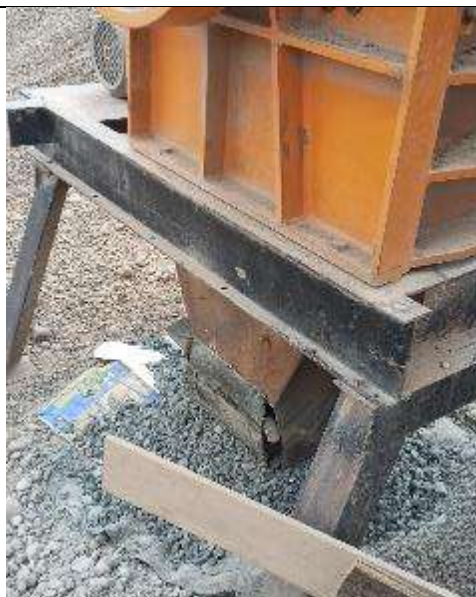
Fotografía 05: Trituración de roca sienita TM = 11/2” Trituradora de mandíbulas – Cantera temporal de Rosario
