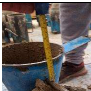
Fotografía 19: Ensayo de consistencia del concreto
