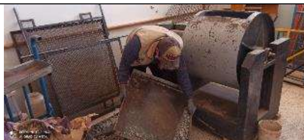
Fotografía 16: Ensayo de abrasión – máquina de los angeles
