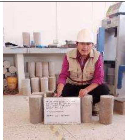
Fotografía 24: Rotura de probetas a compresión – sustitución al 100% sienita como agregado grueso
