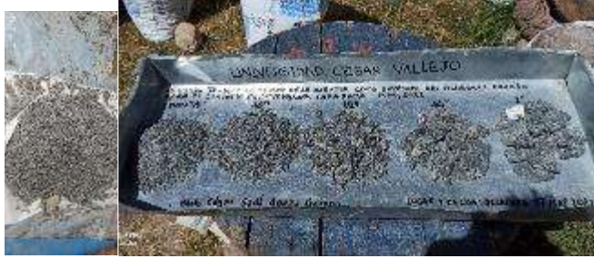
Fotografía 07: Crivado y granulometría del agregado – roca triturada sienita nefelinica
