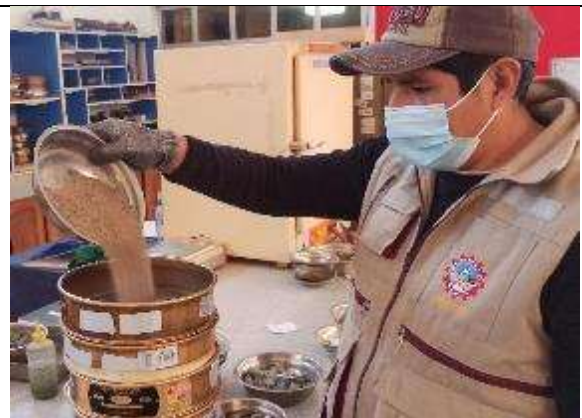
Fotografía 14: Análisis granulométrico agregado fino
