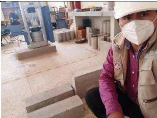
14 y 28 días Fotografía 27: Muestras prismáticas – ensayos a flexión
