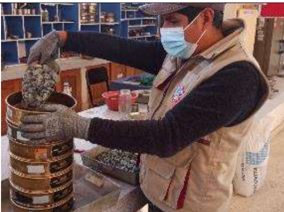
Fotografía 13: Análisis granulométrico agregado grueso
