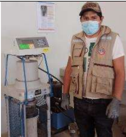
Fotografía 23: Rotura de probetas - compresión uniaxial
