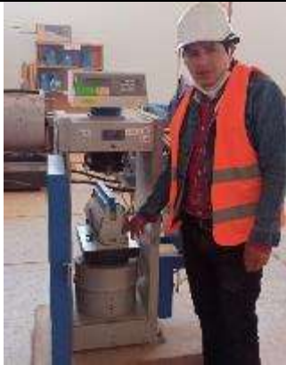
Fotografía 25: Rotura de probetas a Tracción – sustitución al 100% sienita como agregado grueso
