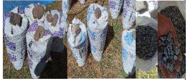
Fotografía 08: Ensacado de agregado – roca sienita Ollache para traslado laboratorio UANCV - JULIACA
