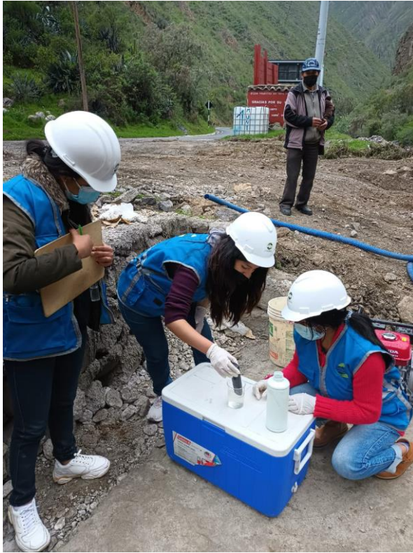
Monitoreo de las aguas residuales del anexo de Llapay
