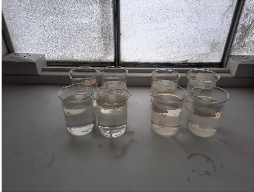
Muestras para el análisis de laboratorio de turbidez y \text{dbO}_5 de las aguas residuales
