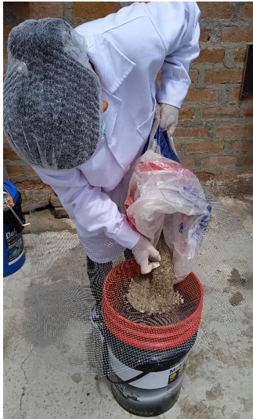
Uso de la malla granulométrica para el acondicionamiento de los filtros.
