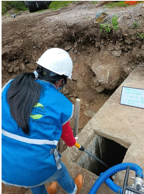
Punto de muestreo para la toma de muestras de las aguas residuales del anexo de Llapay
