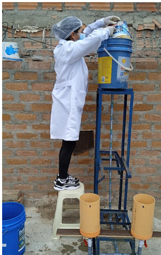
Construcción del lecho filtrante para la evaluación de turbidez y \text{db}_5 de las aguas residuales.
