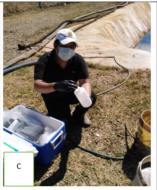
**Figura N° 07:** Recolección de muestras, (a) tubería de efluente, (b) poza de lixiviados N°01 toma de muestra dbó5, (c) poza de lixiviados N° 02 toma de muestras coliformes totales.
