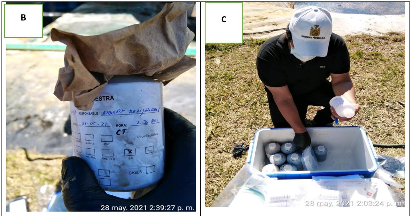
**Figura N° 08:** Recolección de muestras, (a) tubería de efluente, rotulado de la muestra (b) poza de lixiviados n°01 toma de muestra CT, (c) poza de lixiviados N° 02 procedimiento de la preservación de las muestras.
