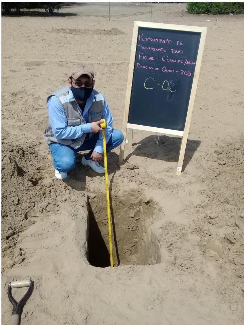
Fotografía 1 Excavación de Calicatas
