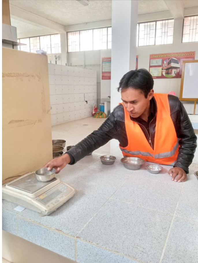
Pesado de las muestras pasantes por las mallas para análisis granulométrico
