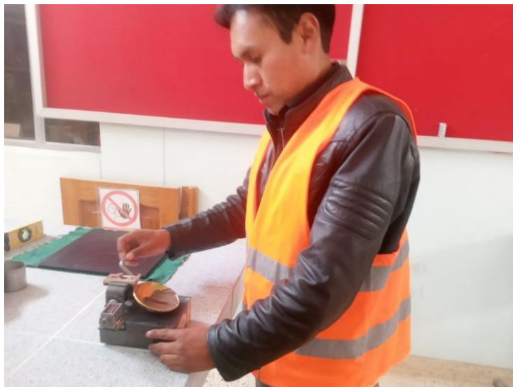
Figura 44. Ensayo en laboratorio para saber las características del límite de consistencia
