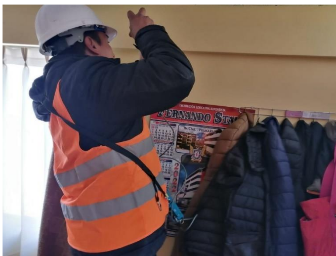
Figura 58. Prueba de esclerómetro en viga – vivienda 02
