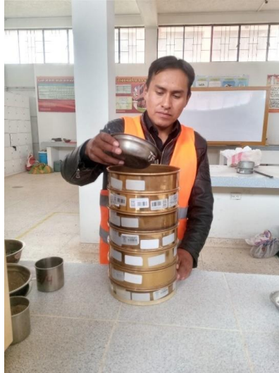
Figura 25. Ensayo en laboratorio para el análisis granulométrico del suelo Fuente: Elaboración propia
