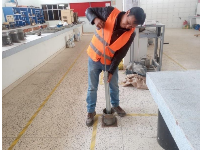
Figura 46. Ensayo de laboratorio en Proctor Modificado
