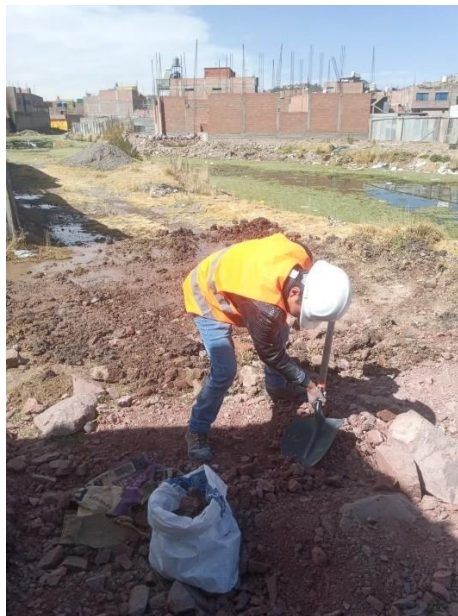
Figura 45. Obtención de muestra para ensayo de Proctor
