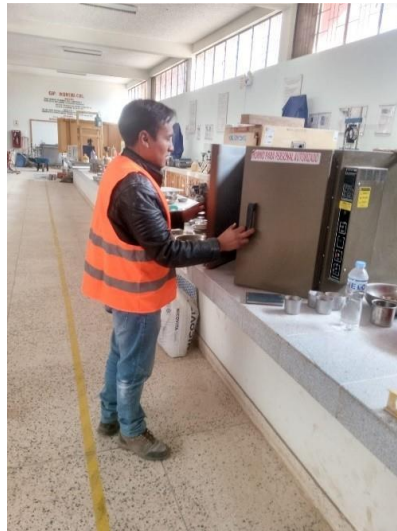
Figura 24. Ensayo en laboratorio para determinar contenido de humedad
