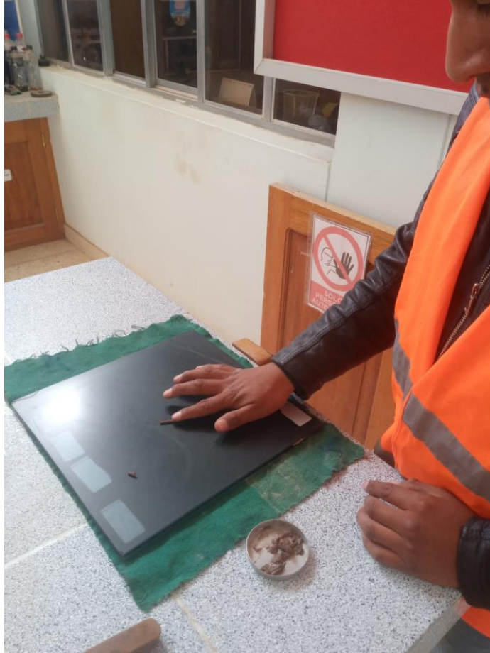
Ensayo de laboratorio para determinar el límite plástico
