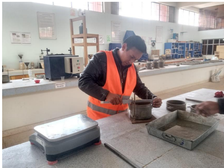
Toma de medidas del cilindro para realizar ensayo de Proctor
