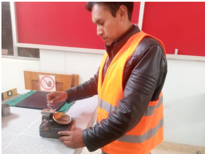
Ensayo de laboratorio con el instrumento casa grande para determinar el límite líquido
