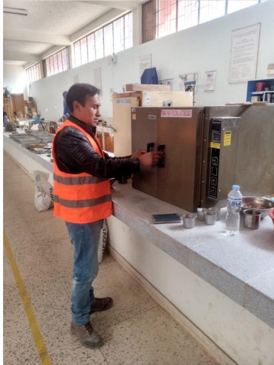
Ensayo en laboratorio para determinar contenido de humedad
