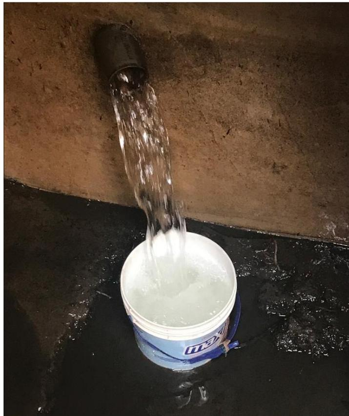
**Fotografía N° 04:** Vista del aforo de la fuente.
