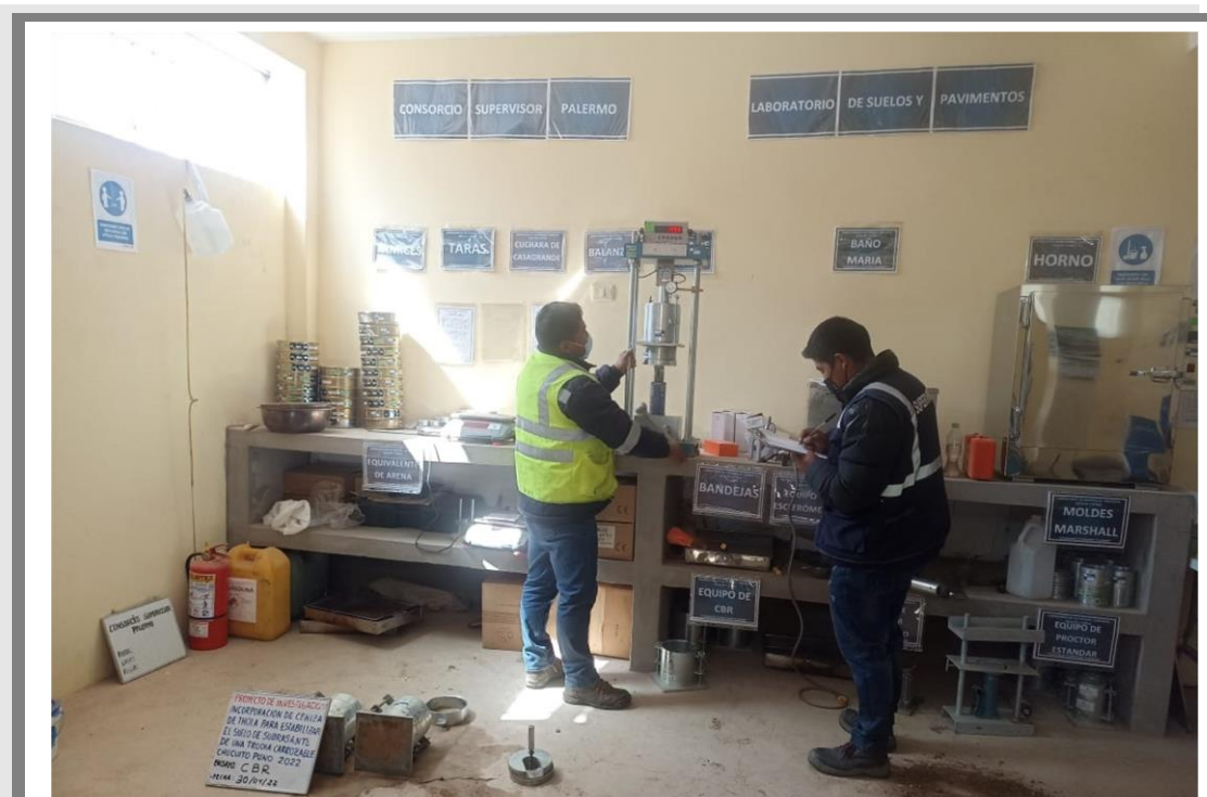
FOTOGRAFIA N° 12: MEDICIÓN DE CAPACIDAD DE SOPORTE
