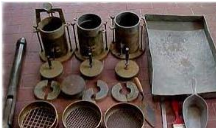
Figura 10. Moldes para compactación.
