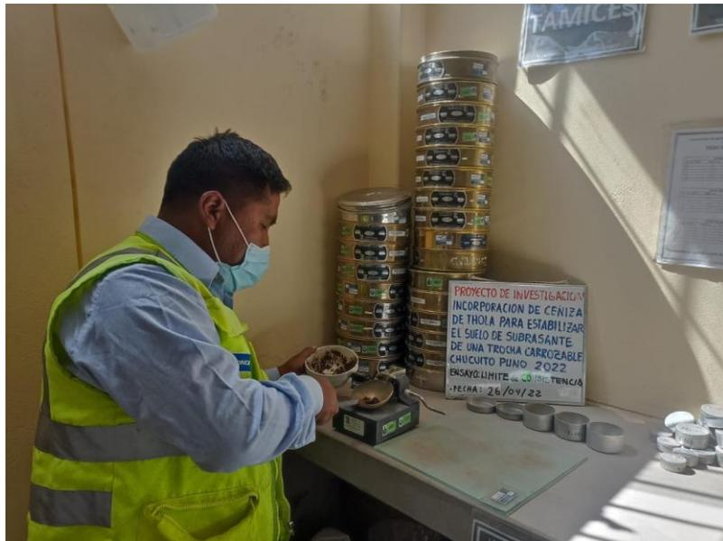
Figura 18. Determinación de límite líquido y límite plástico.
