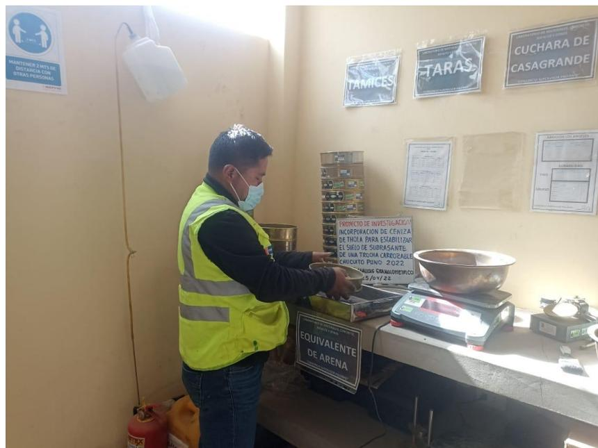
Figura 17. Ensayo análisis granulométrico por tamizado.
