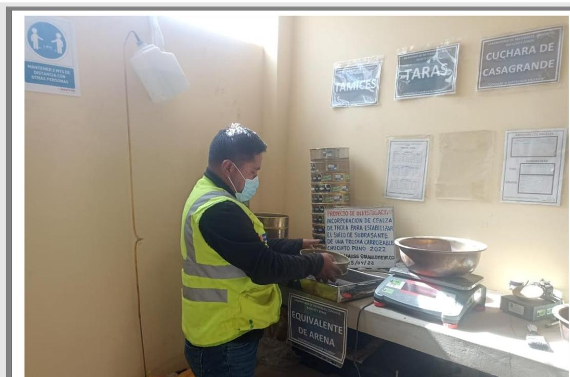
FOTOGRAFIA N° 06: ENSAYO ANALISIS GRANULOMÉTRICO
