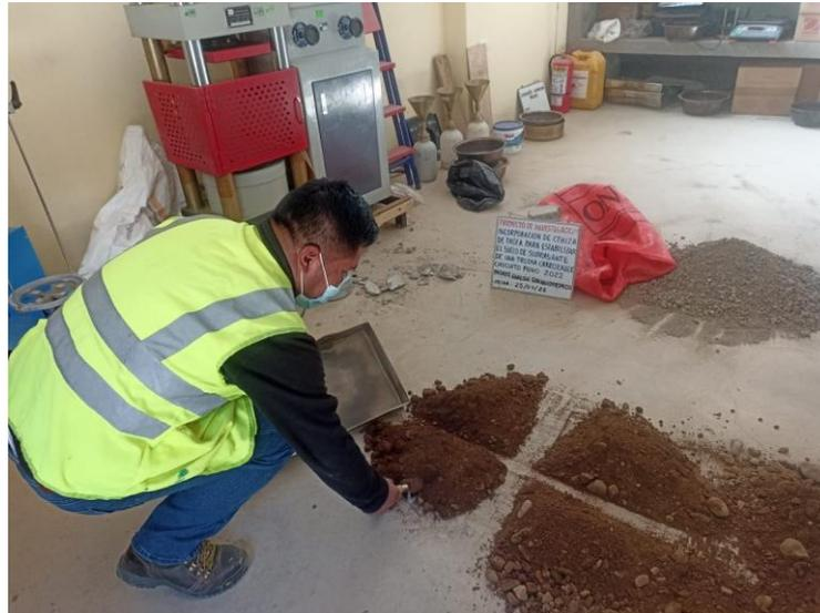
Figura 16. Obtención de una muestra representativa.
