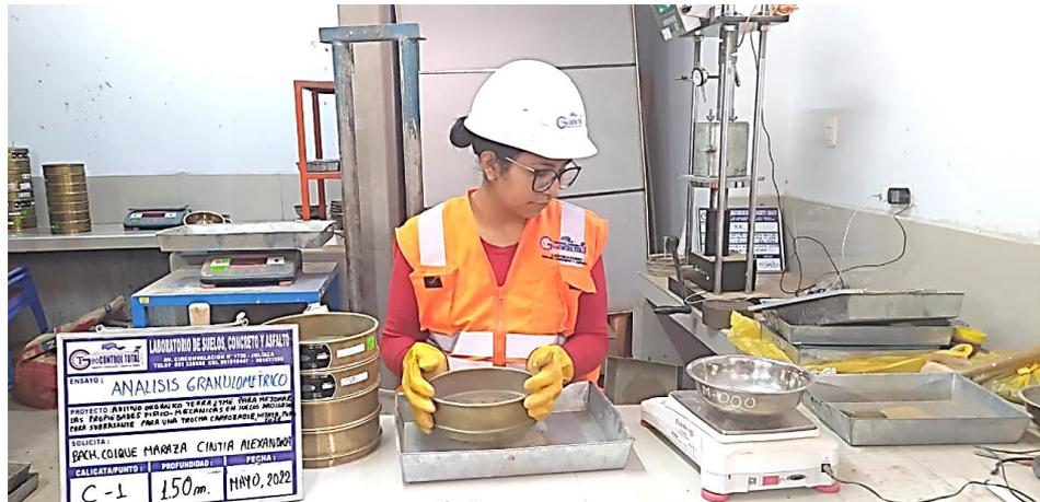
Figura 14. Ensayo de granulometría.
