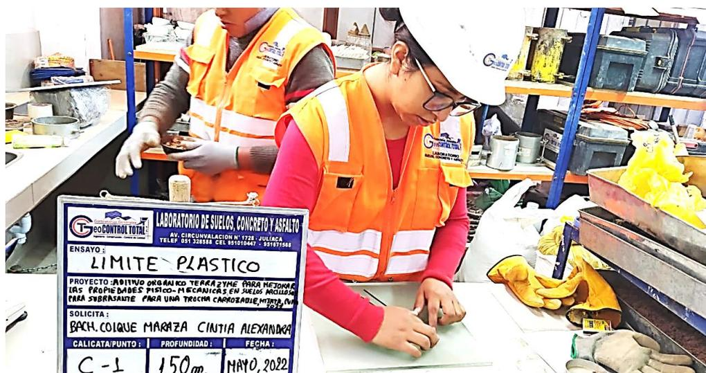
Figura 16. Ensayo de Limite Plástico.
