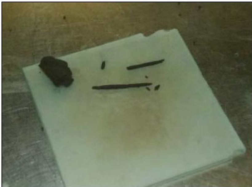
*Figura 09.* Ensayo de limite plástico
