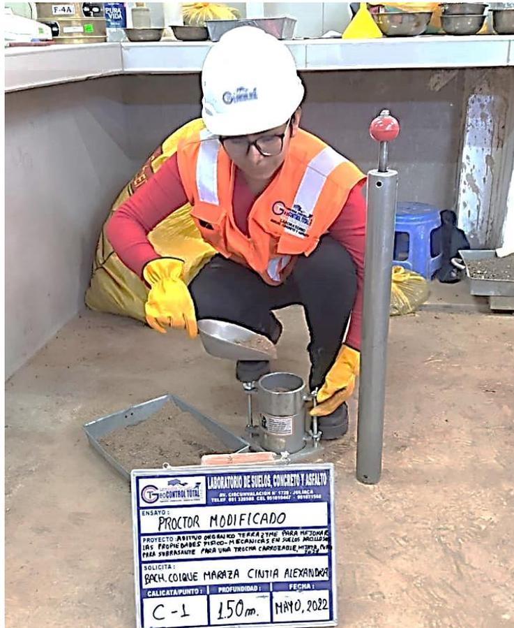
Figura 17. Ensayo Proctor Modificado.
