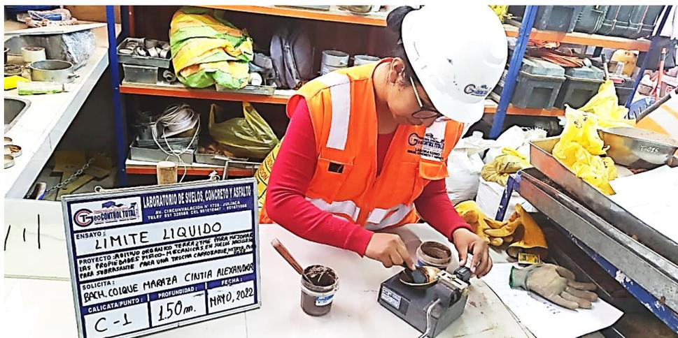
Figura 15. Ensayo de Límite líquido.
