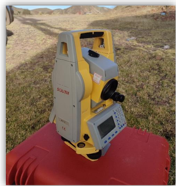
Figura N° 8. Estación Total electrónico para el levantamiento topográfico.
