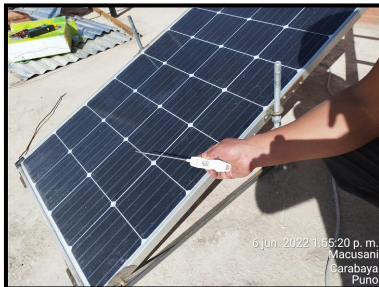
Figura 22: Medida de temperatura. Fuente: Elaboración propia
