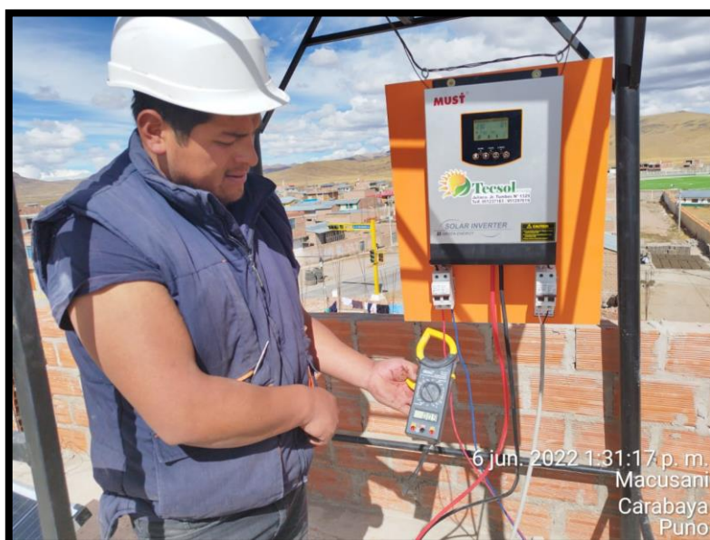
Figura 23: Pruebas físicas de inversor de energía Fuente: Elaboración propia
