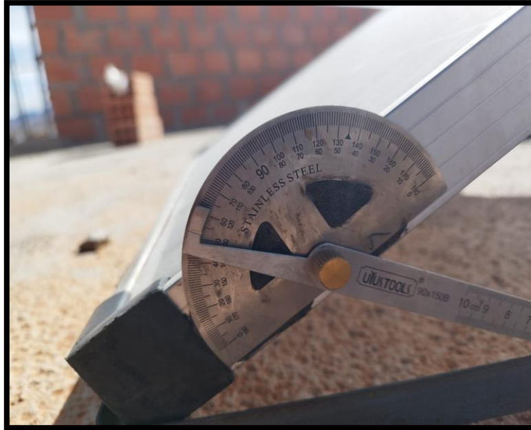
Figura 21: Medida del ángulo de inclinación del panel solar. Fuente: Elaboración propia
