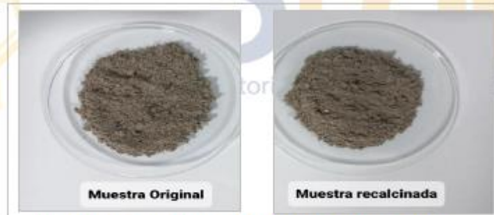
FIGURA N°2: MUESTRA ANTES Y DESPUES DE LA RECALCINACIÓN
