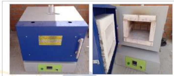
FIGURA N°1: MUFLA USADA EN LA CALCINACIÓN CONTROLADA
