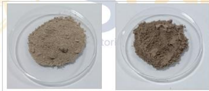
FIGURA N°2: MUESTRA ANTES Y DESPUES DE LA RECALCINACIÓN
