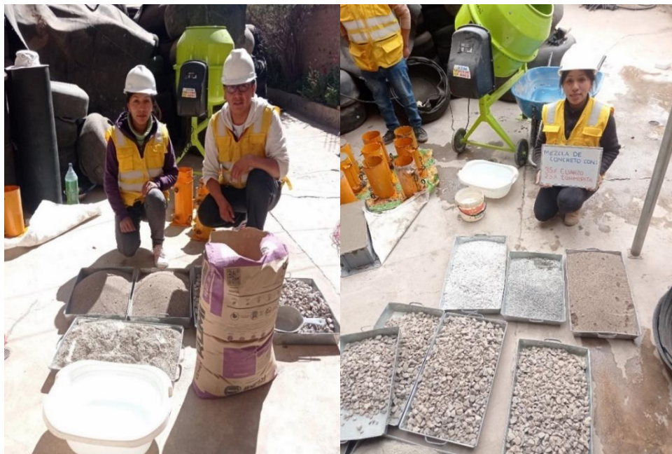
Figura 44. Materiales utilizados para las diferentes mezclas de concreto.
