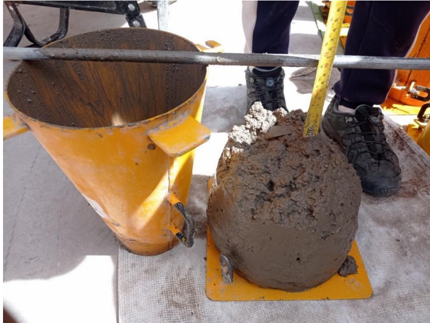
Figura 53. Medición del asentamiento con un flexómetro.
