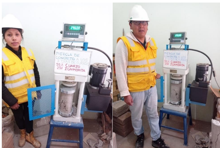
Figura 58. Falla de la probeta a la compresión.
