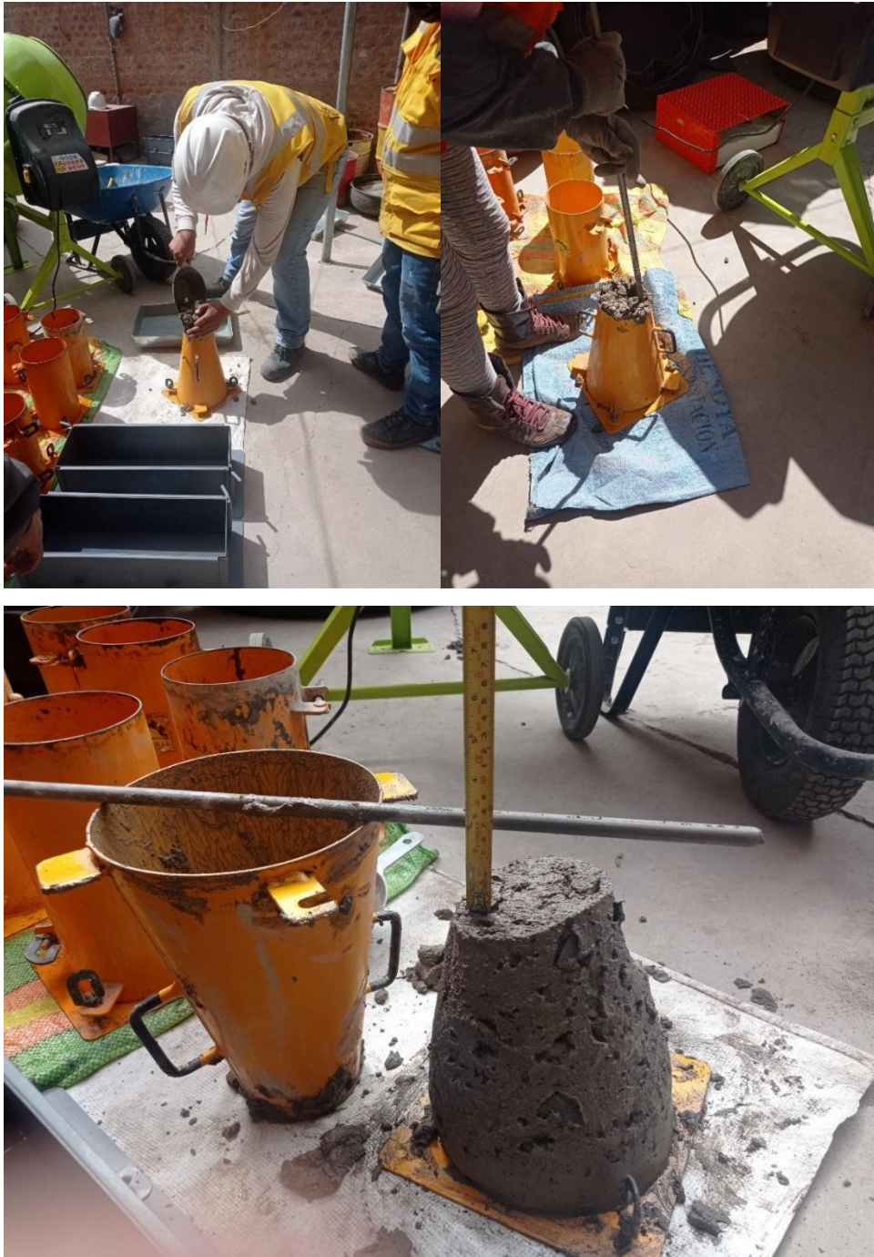
Figura 47. Ensayo de slump.
