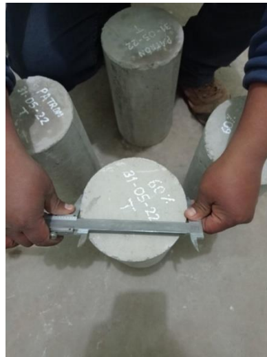
Figura 59. Medida del diámetro de la probeta con vernier para el ensayo de la resistencia a la tracción indirecta.
