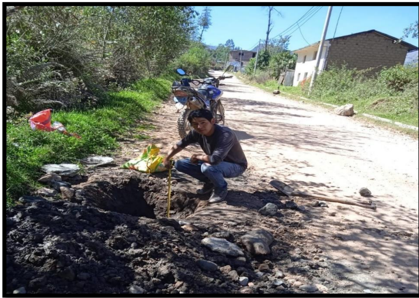
En esta figura se visualiza la extracción de la muestra de suelo 20 kg C-02.
