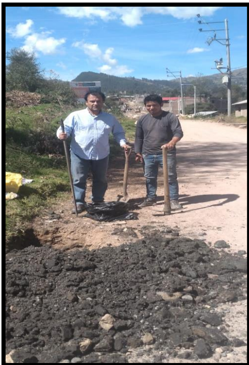
En esta figura se visualiza la profundidad de la calicata de 1.40 m ya el suelo se encuentra con porcentaje de humedad moderada.
