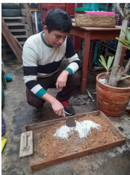
Figura N° 16: Elaboración de adobe experimental en 3% en la ciudad de Tauca.
