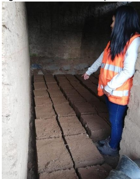
Figura N° 7: Adobes en proceso de secado.
