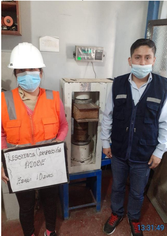
Figura N° 42: Ensayo de Resistencia a la compresión de los adobes a 10 días.
