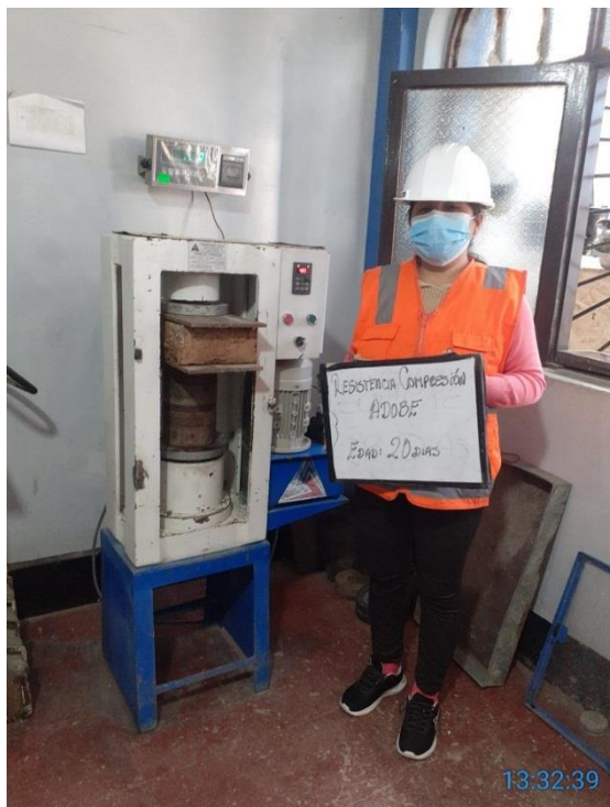
Figura N° 43: Ensayo de Resistencia a la compresión de los adobes a 20 días.
