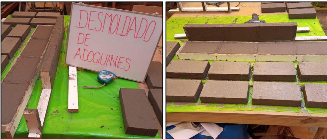
*Figura 28. Desmoldado de los adoquines.*
