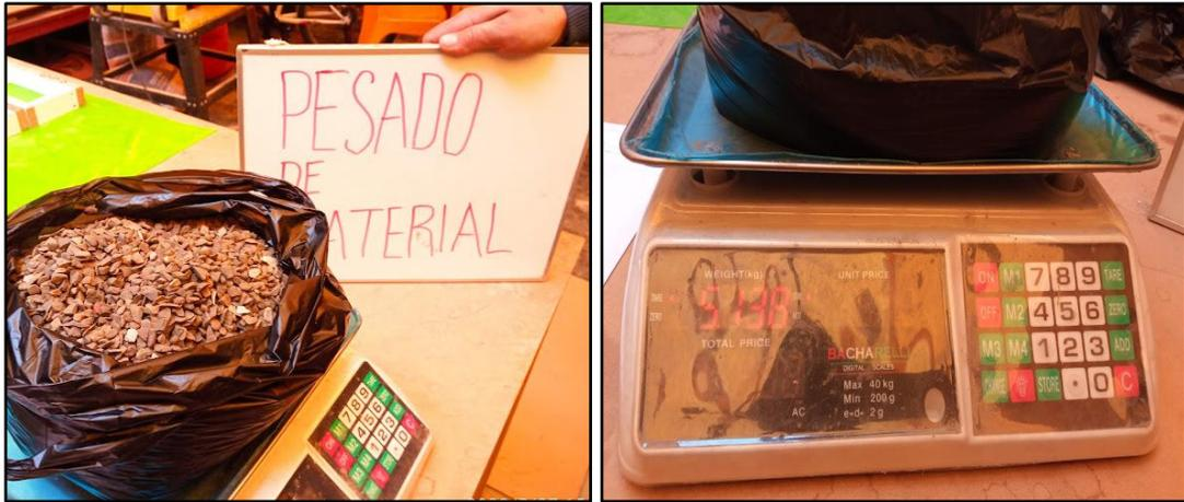
*Figura 25.* Pesaje de los materiales para la fabricación de adoquines.
