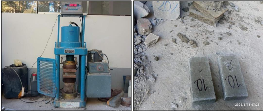
Figura 31. Rotura de adoquines.
