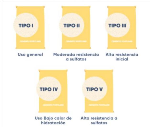
Figura 2. Tipos de cemento.
