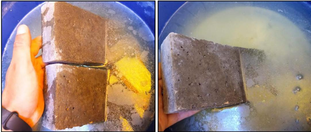
*Figura 29. Curado de los adoquines.*
