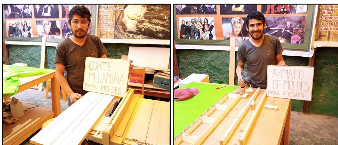
*Figura 24.* Corte y armado de los moldes para la fabricación de adoquines.
