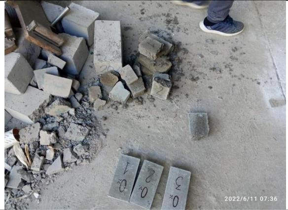
**Comentario:** Adoquines sometidos al ensayo de resistencia de compresión.
