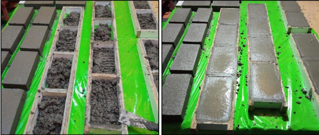
*Figura 27. Vaciado de los adoquines.*
