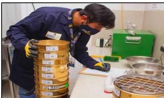
Figura 16. Tamizado de los agregados.
