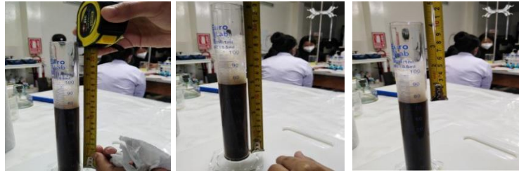
Figura 121. Medición de la espuma generada.
