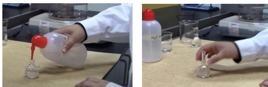
Figura 53. Picnómetro tapado y lleno de agua destilada
