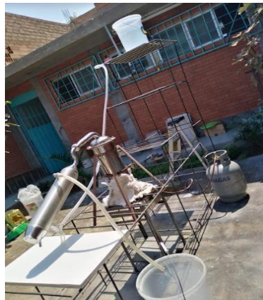
Figura 159. Extracción del aceite de café
