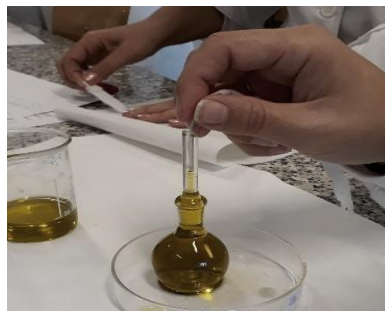
Figura 56. Llenado del picnómetro de aceite
