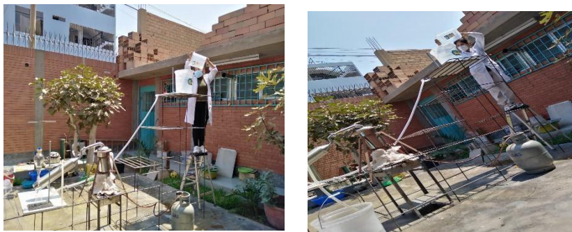
Figura 30. Recarga de agua fría al recipiente superior.
