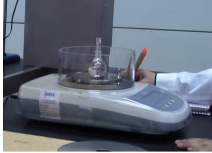
Figura 54. Pesado del picnómetro
