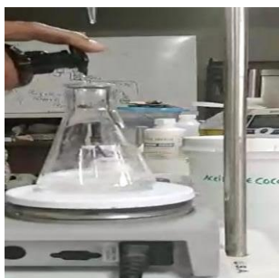
Figura 42. Agregado de fenolftaleína a la muestra
