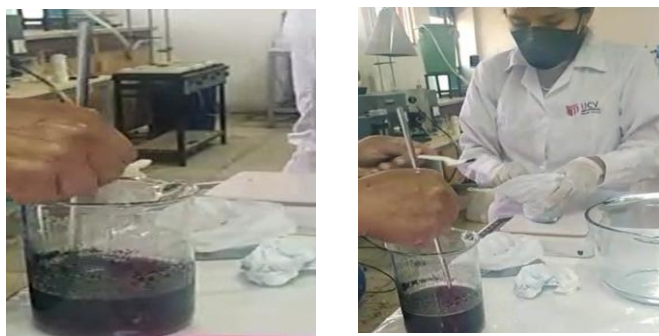
Figura 70. Vertimiento de la borra en la mezcla
