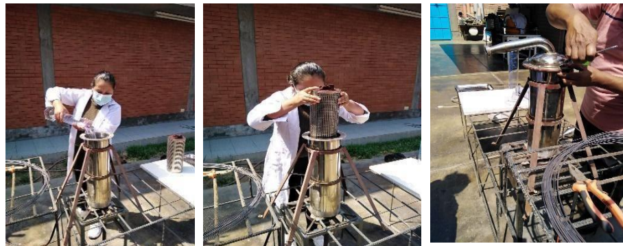
Figura 28. Vertimiento de agua destilada y sellado del reactor.
