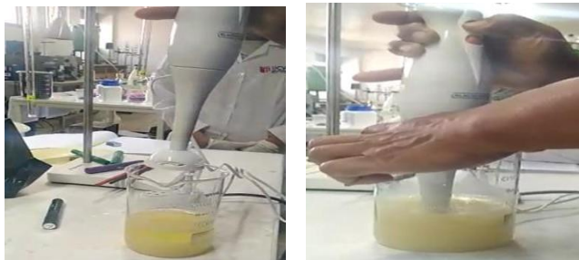
Figura 69. Batido de la mezcla (grasas, glicerina y NaOH)
