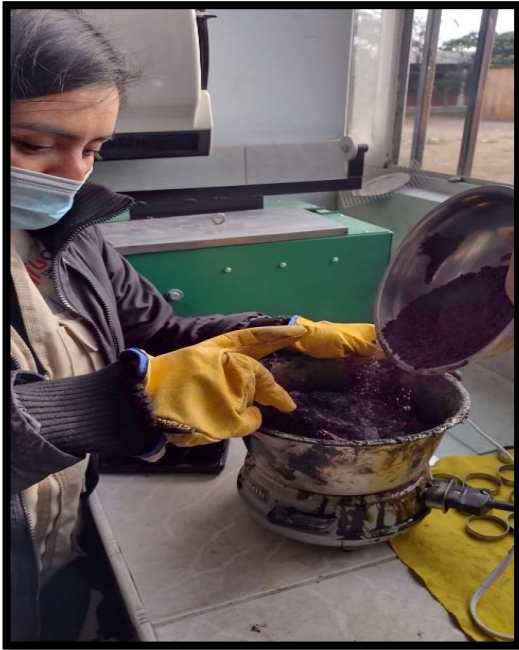
Preparación de la mezcla asfáltica
