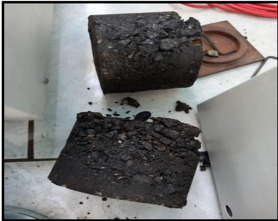
Rotura de briquetas
