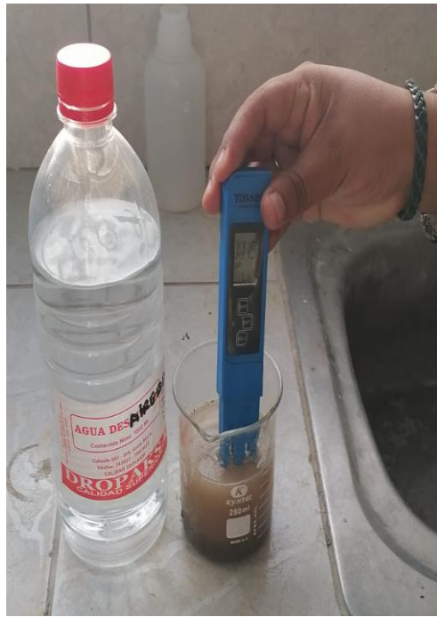
Foto N° 19: Segunda medición de las sales solubles
