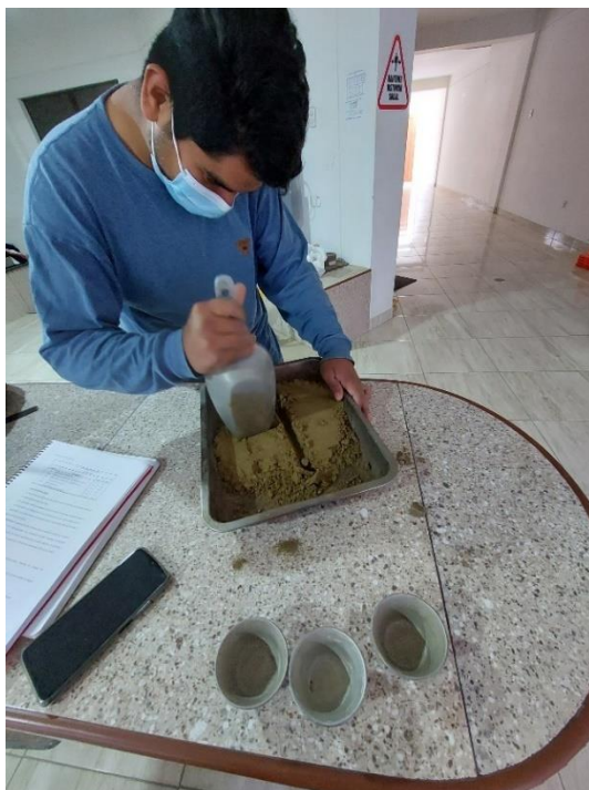
Tesista Romero preparando la muestra para ensayo de contenido de humedad
