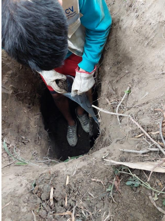
Tesista Gutiérrez extrayendo muestras de la calicata C-3
