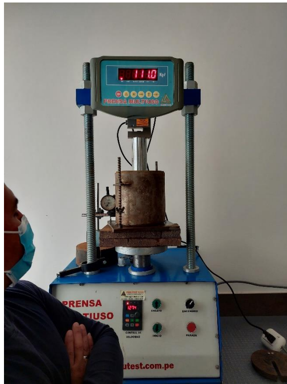
Aplicación de carga para el ensayo de penetración
