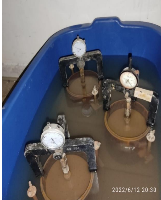
Ensayo de expansión de las muestras de CBR
