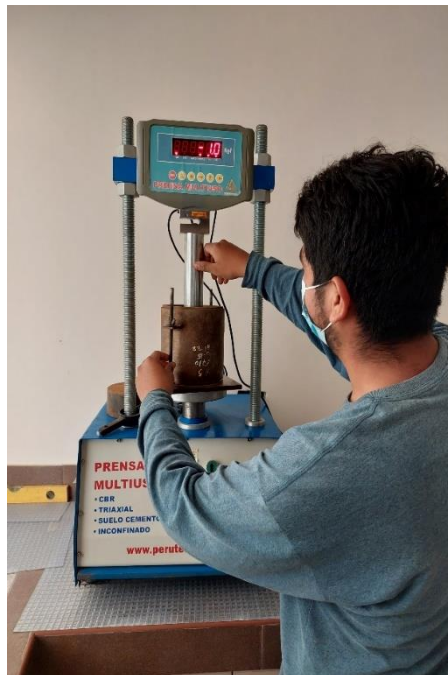
Colocación del molde para el ensayo de penetración.
