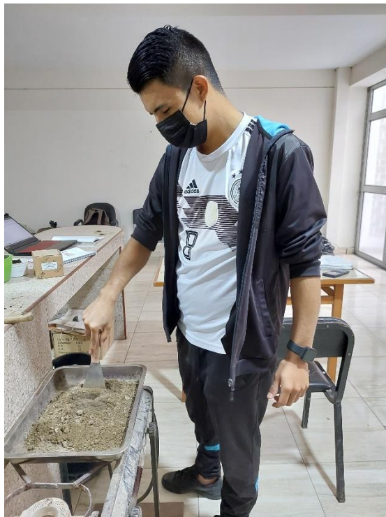
Tesista Gutiérrez secando la muestra tomada para el ensayo de granulometría de la calicata C-1.
