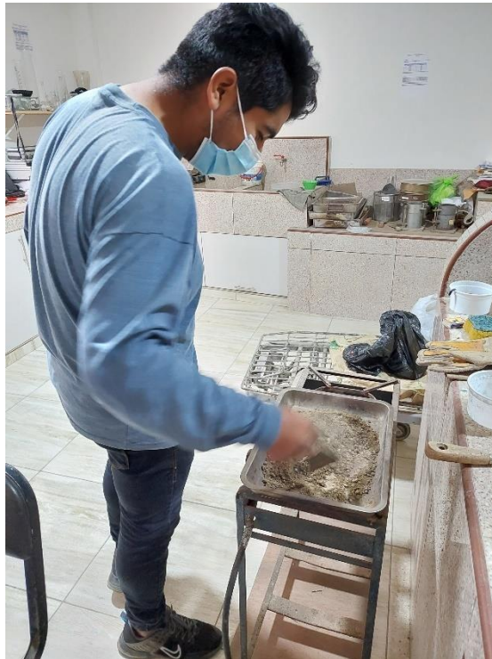
Tesista Gutiérrez secando la muestra tomada para el ensayo de granulometría de la calicata C-2
