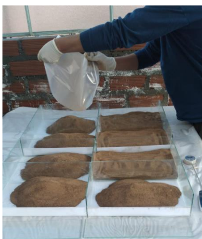
Figura 9. Muestras de suelo acondicionadas en 8 recipientes de 20 cm x 10 cm x 8 cm.
