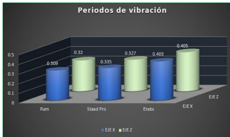
Figura 81. Comparación de los periodos de vibración.
