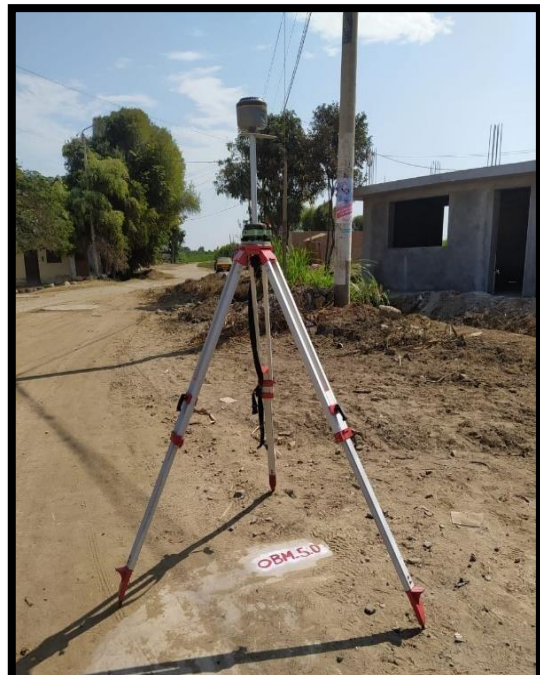
Figura 3. Toma de datos con GPS
