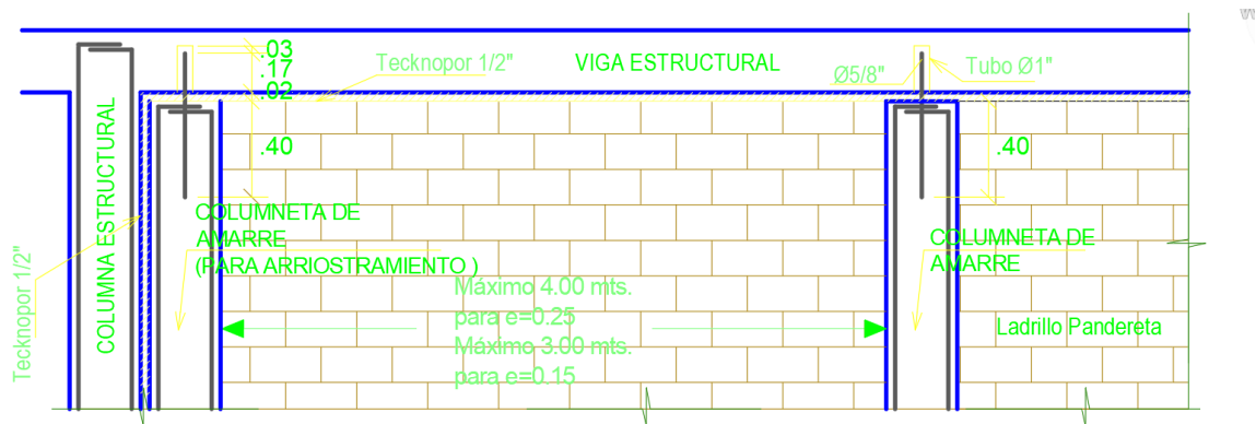
Figura 8. Aislamiento de los elementos
