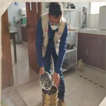
Realizando la granulometría de la gravilla
