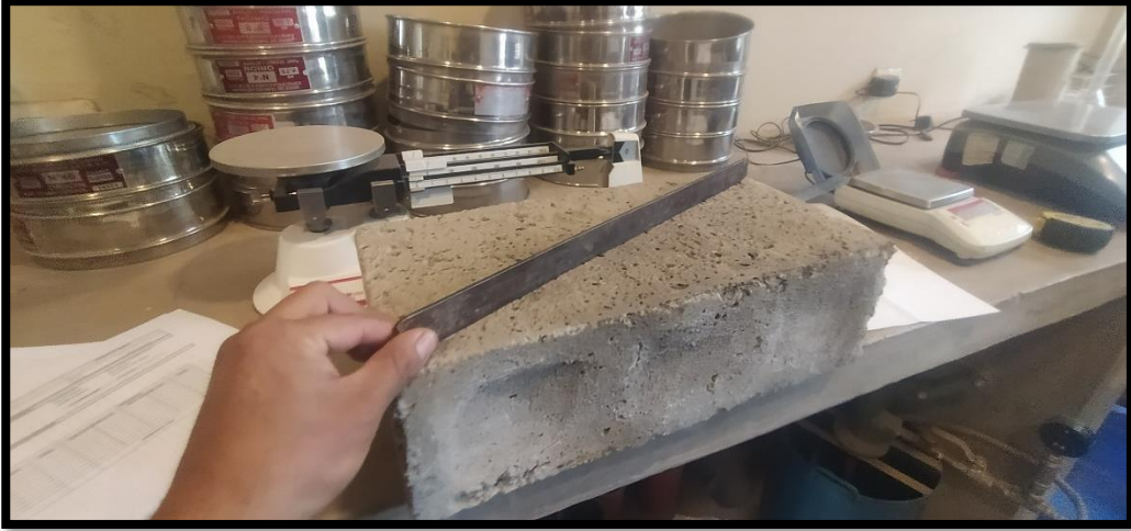
FOTO 01: SE REALIZA EL ENSAYO DE ALABEO AL BLOQUE DE CONCRETO
