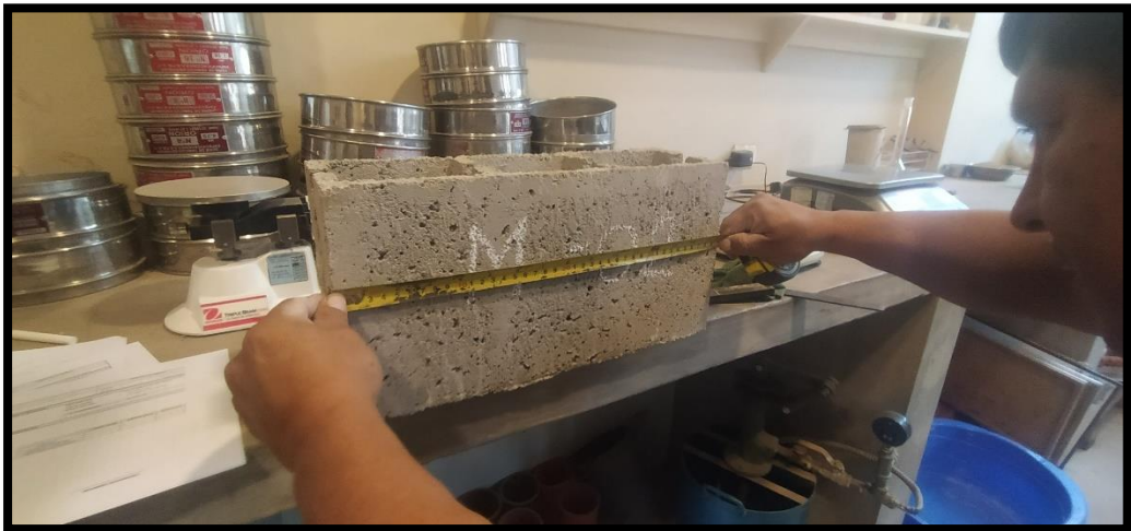
FOTO 02: SE REALIZA EL ENSAYO DE VARIACIÓN DIMENSIONAL DEL BLOQUE DE CONCRETO
