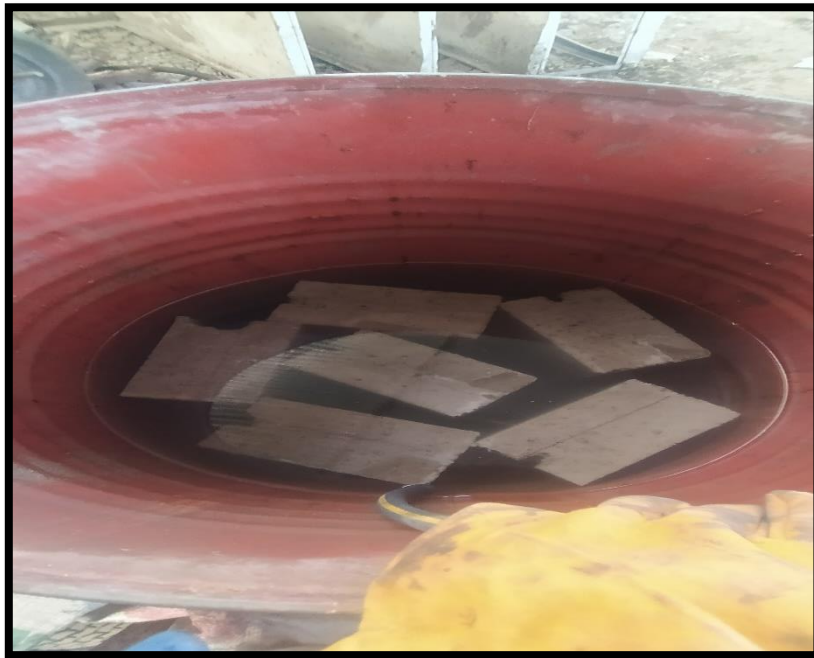
FOTO 03: SE REALIZA EL ENSAYO DE SUCCION DEL BLOQUE DE CONCRETO
