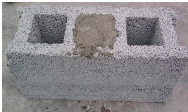
Figura 1. Bloque de Concreto.
