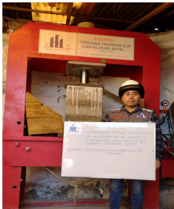
FOTO 08: SE REALIZA EL ENSAYO DE RESISTENCIA AXIAL DE LAS PILAS DE BLOQUE DE CONCRETO.
