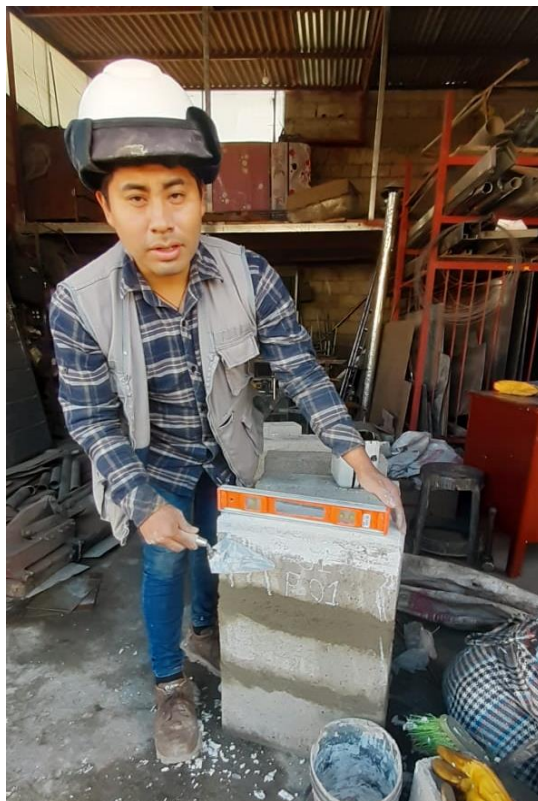
FOTO 04: SE REALIZA EL ASENTADO DEL LOS BLOQUES DE CONCRETO PARA EL ENSAYO DE RESISTENCIA AXIAL
