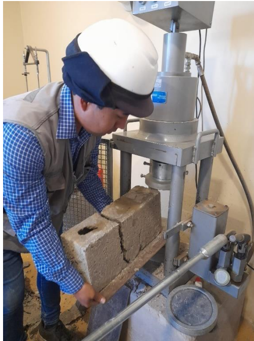
FOTO 05: SE REALIZA EL ENSAYO DE RESISTENCIA A LA COMPRESION.
