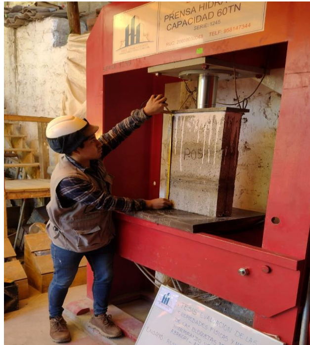
FOTO 07: SE REALIZA EL ENSAYO DE RESISTENCIA AXIAL DE LAS PILA. TOMA DE MEDIDAS.
