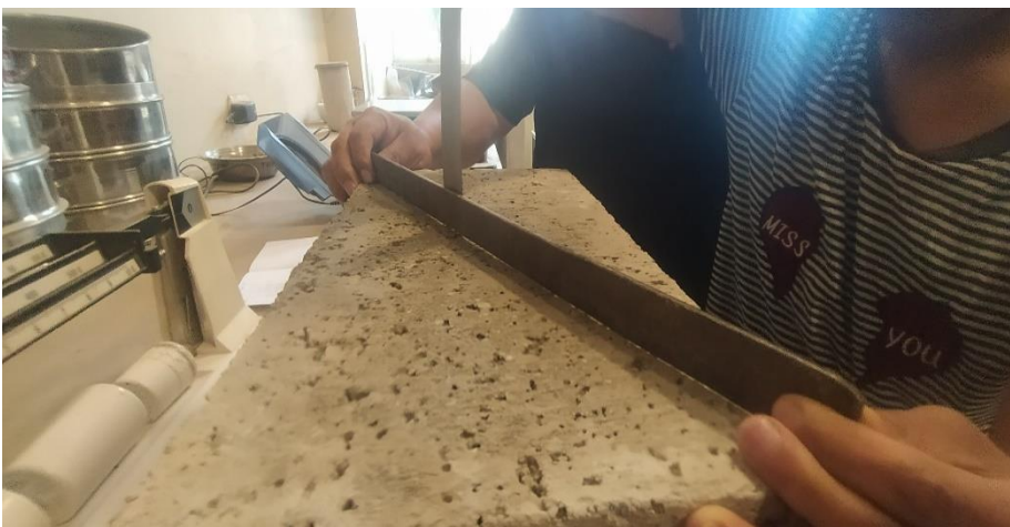
Figura 10. Ensayo de alabeo
