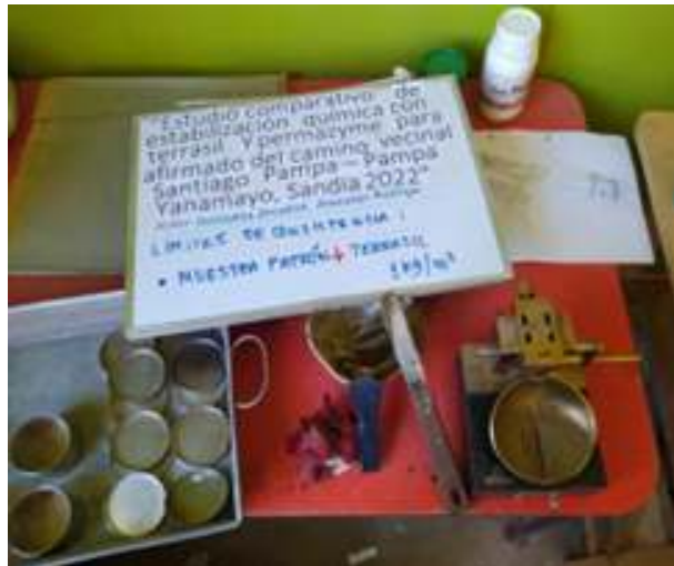
Imagen 32. Cuchara de Casagrande con muestra patrón y terrasil.
