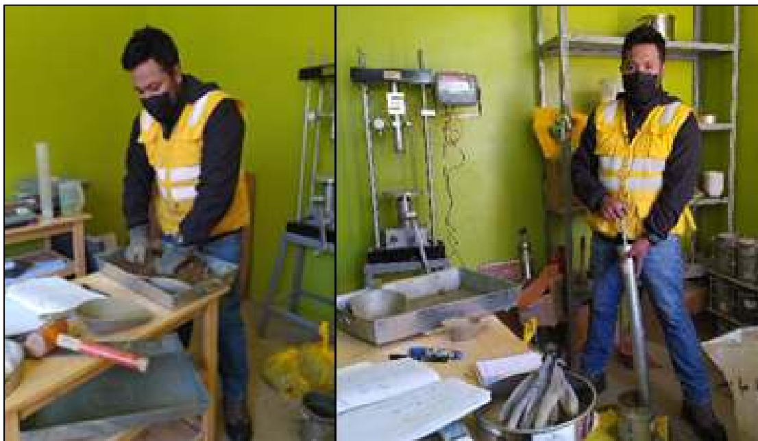
Imagen 56. Mezclado y compactado de la muestra con permazyme.
