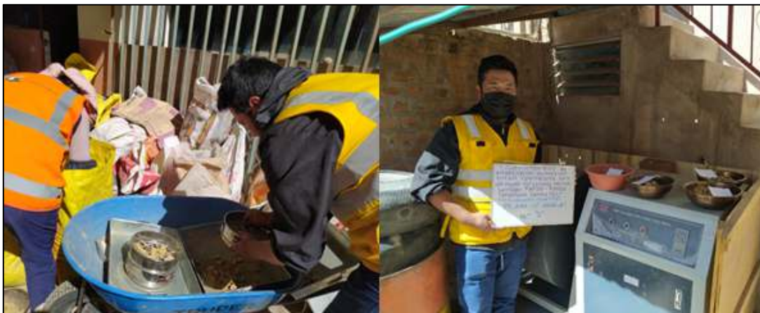
Imagen 30. Tamizado y colocado de muestras para la prueba de abrasión.
