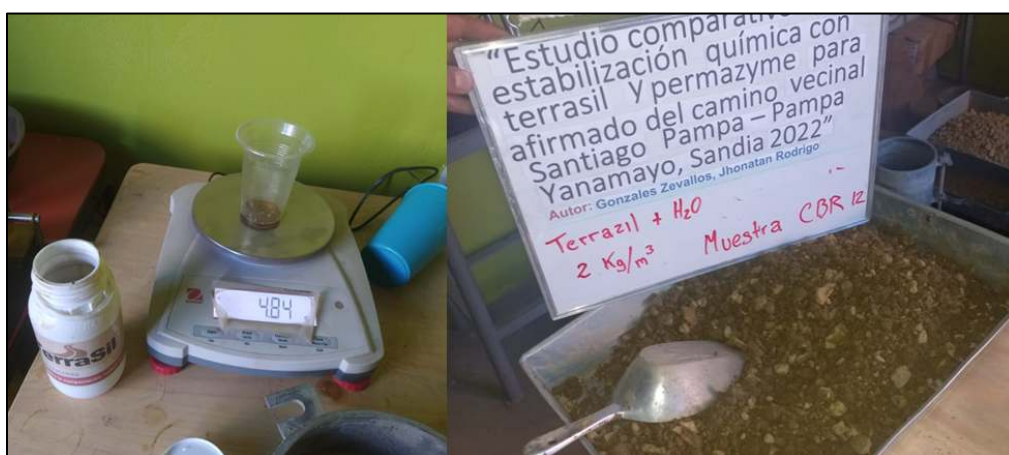
Imagen 41. Dosificación y preparación de la muestra para CBR.
