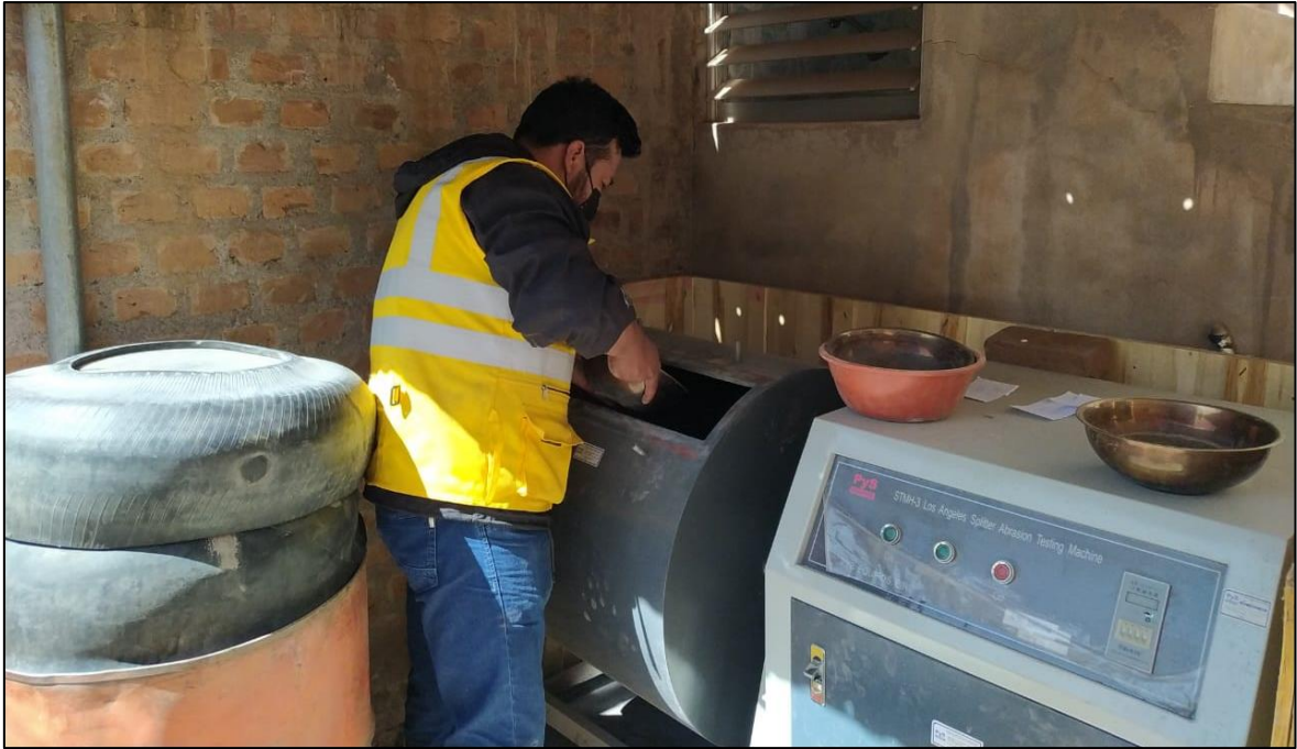
Fotografía 24. Se coloca el material tamizado para realizar el ensayo de abrasión.
