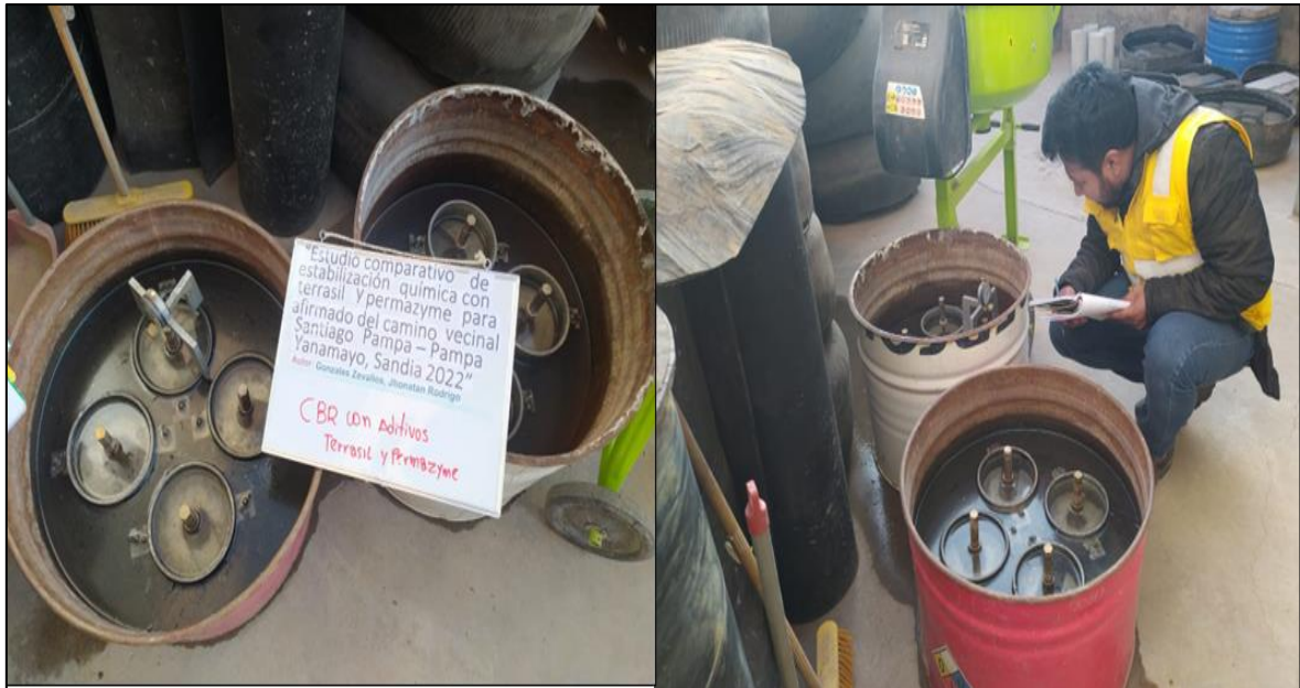
Fotografía 32. Sumersión de muestras con aditivo para el cálculo de CBR
