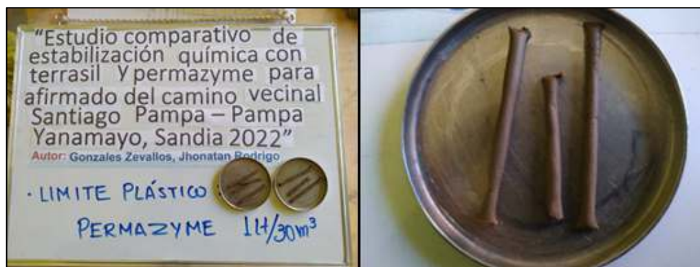
Imagen 51. Límite plástico, cilindros de muestra con permazyme.
