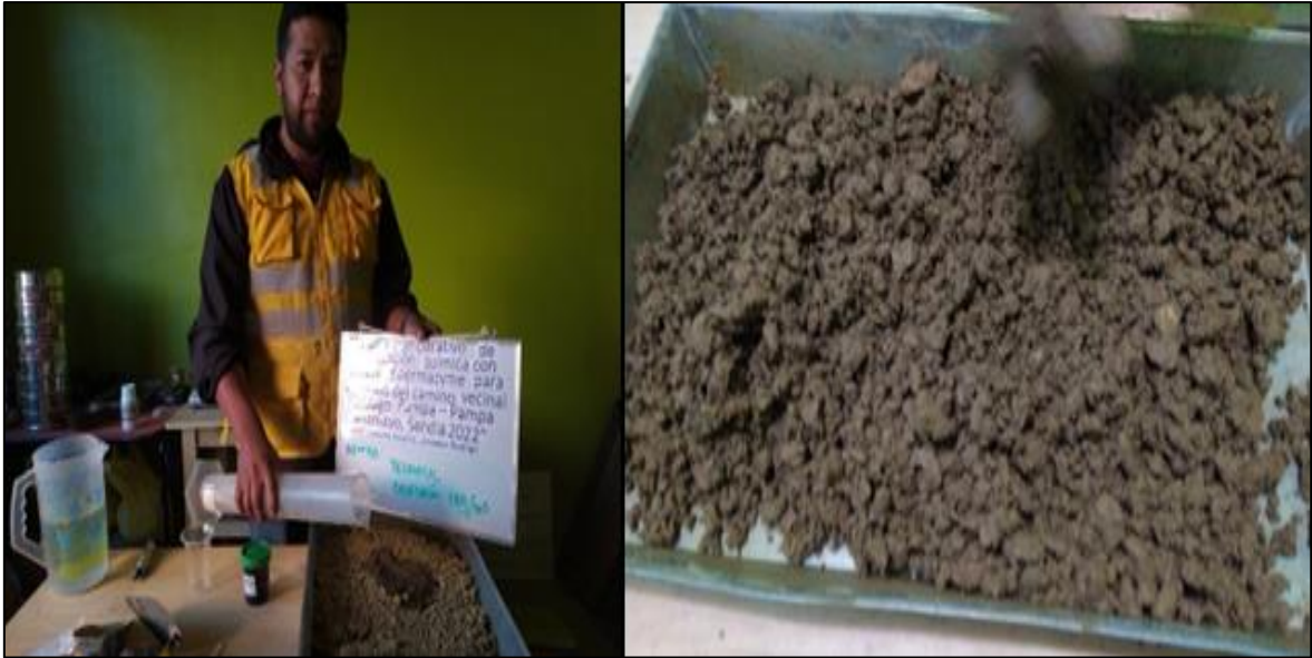
Fotografía 28. Se vierte el agua con aditivo para poder realizar los ensayos de Proctor modificado y para el ensayo de CBR.
