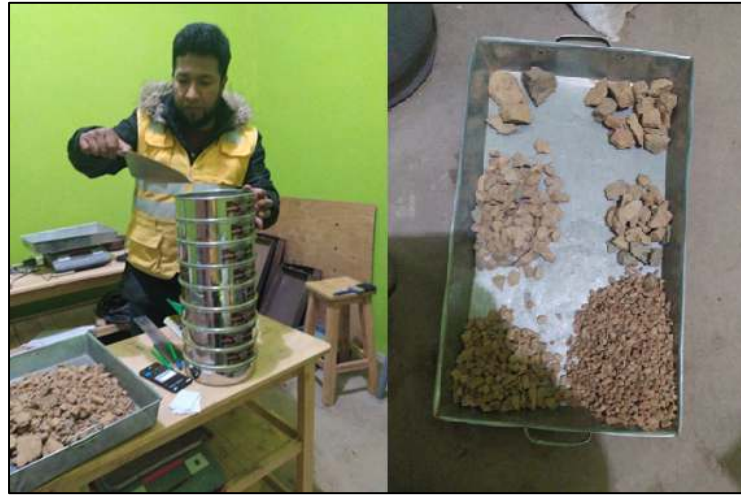
Imagen 16. Tamizado de los agregados proveniente de cantera, elaboración propia.
