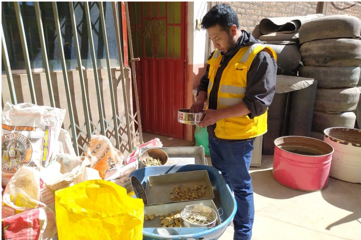
Fotografía 23. Se realiza el proceso de tamizado para la prueba de abrasión por el método A con unos 5003 gr.
