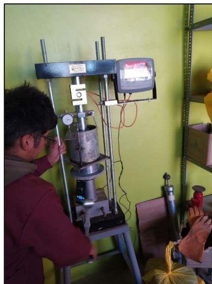
Imagen 60. Proceso de penetración de las muestras con permazyme.
