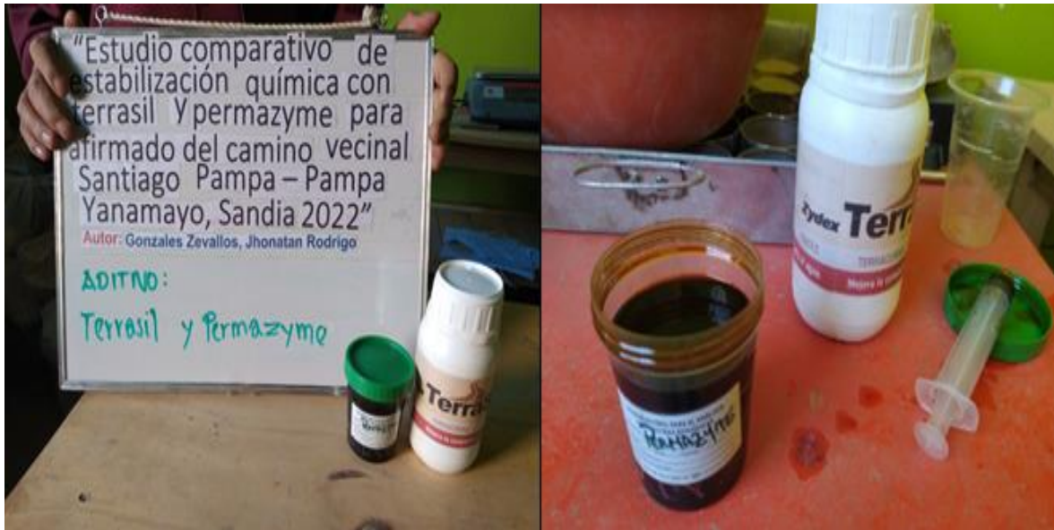
Fotografía 26. Se muestran los aditivos terrasil y permazyme que se utilizaron para la estabilización de la muestra patrón, estos se utilizarán en las proporciones ya mencionadas, con estos se podrán determinar los resultados de mejoras para la estabilización química de la muestra patrón.
