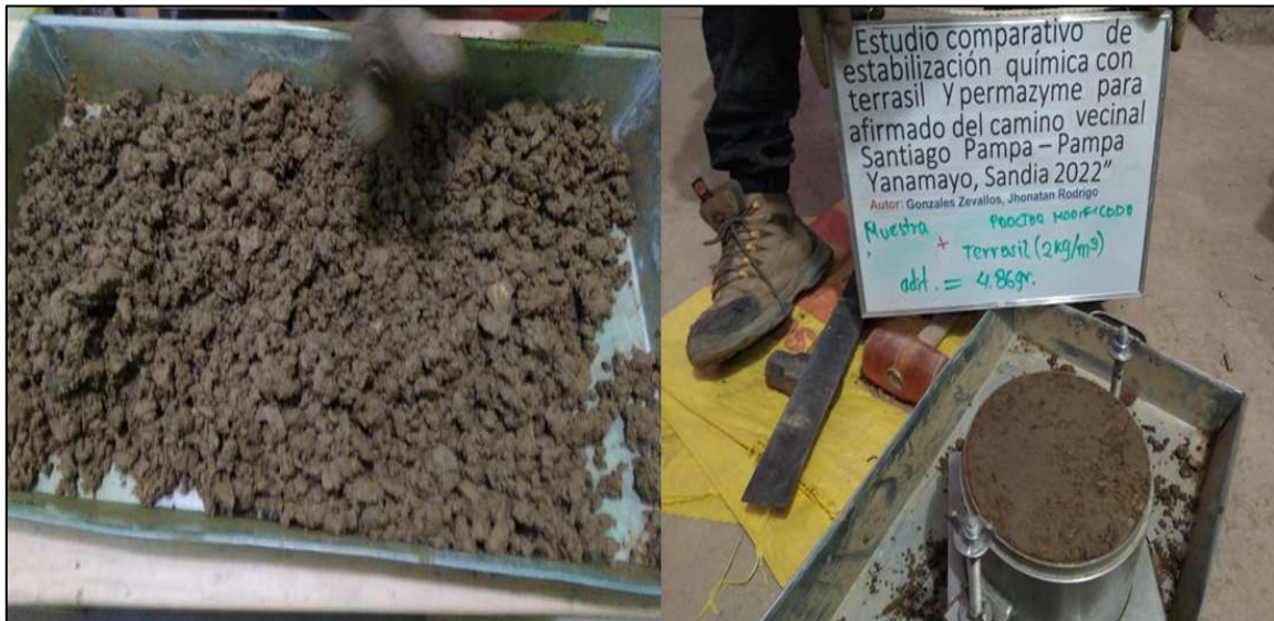
Imagen 38. Muestra combinada con agua y terrasil.
