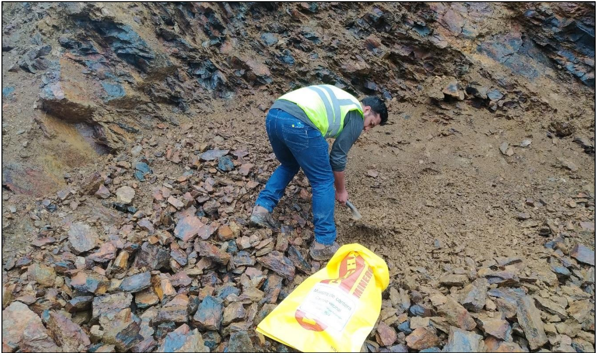
Fotografía 14. Se realiza el trabajo de toma de muestras para realizar los ensayos en el laboratorio.
