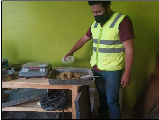
Imagen 23. Humedeciendo la muestra para el ensayo de Proctor modificado.
