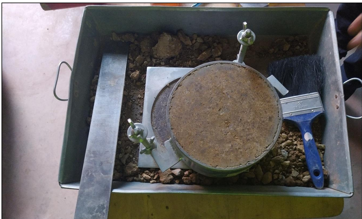
Fotografía 21. Ensayo de Proctor modificado el cual se desarrolla por el método C de la muestra patrón el cual se dio en un compactado de 5 capas con 56 golpes.
