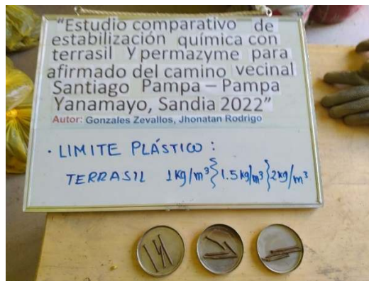
Imagen 33. Límite plástico, cilindros de muestra con terrasil.
