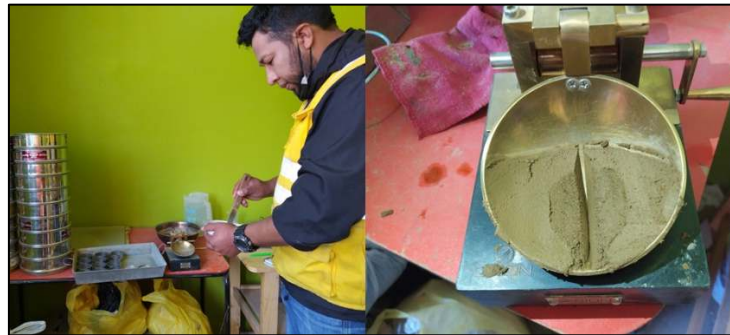
Imagen 20. Trabajo de saturación y uso de la cuchara correspondiente a Casagrande.
