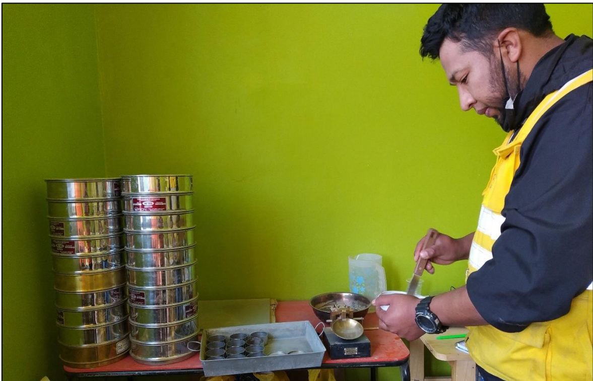
Fotografía 29. Se tiene el ensayo de los límites de consistencia de ambos aditivos.
