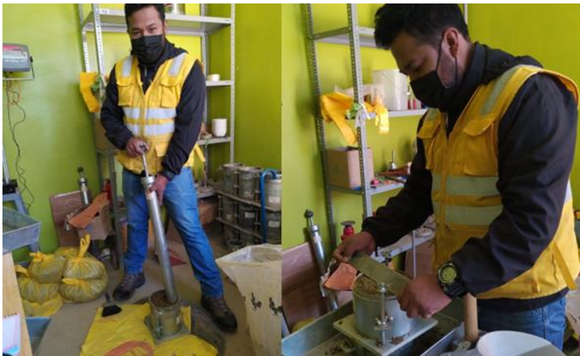
Fotografía 31. Se realiza el trabajo de compactación y perfilado en el ensayo de Proctor modificado.
