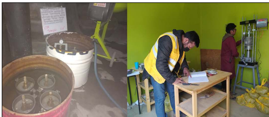
Imagen 42. Muestra sumergida y penetración de muestra con aditivo terrasil.
