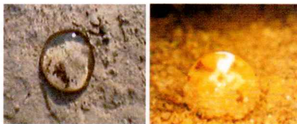
Aspecto de gotas de agua depositadas sobre suelos tratados con TerraSil. Como se puede observar, la repelencia de la gota es total.
