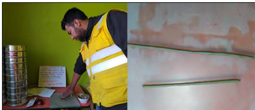
Imagen 21. Elaboración de bastones de 3.2 mm de diámetro.
