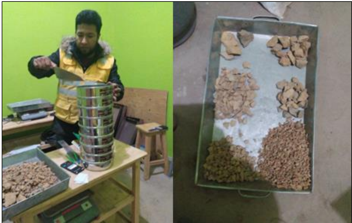
Fotografía 17. Se realiza el ensayo de granulometría para la caracterización del material proveniente de la cantera.
