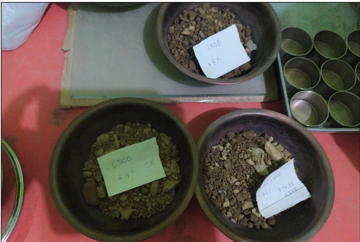
Fotografía 19. Se tiene la muestra saturada con 4%, 6% y 8% de agua para realizar la curva de contenido de humedad.
