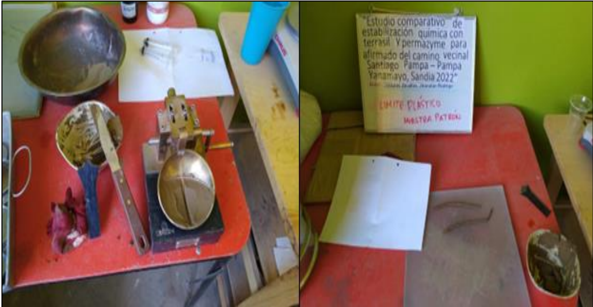
Fotografía 18. Se tiene el material para realizar los ensayos de límite plástico y de límite líquido.
