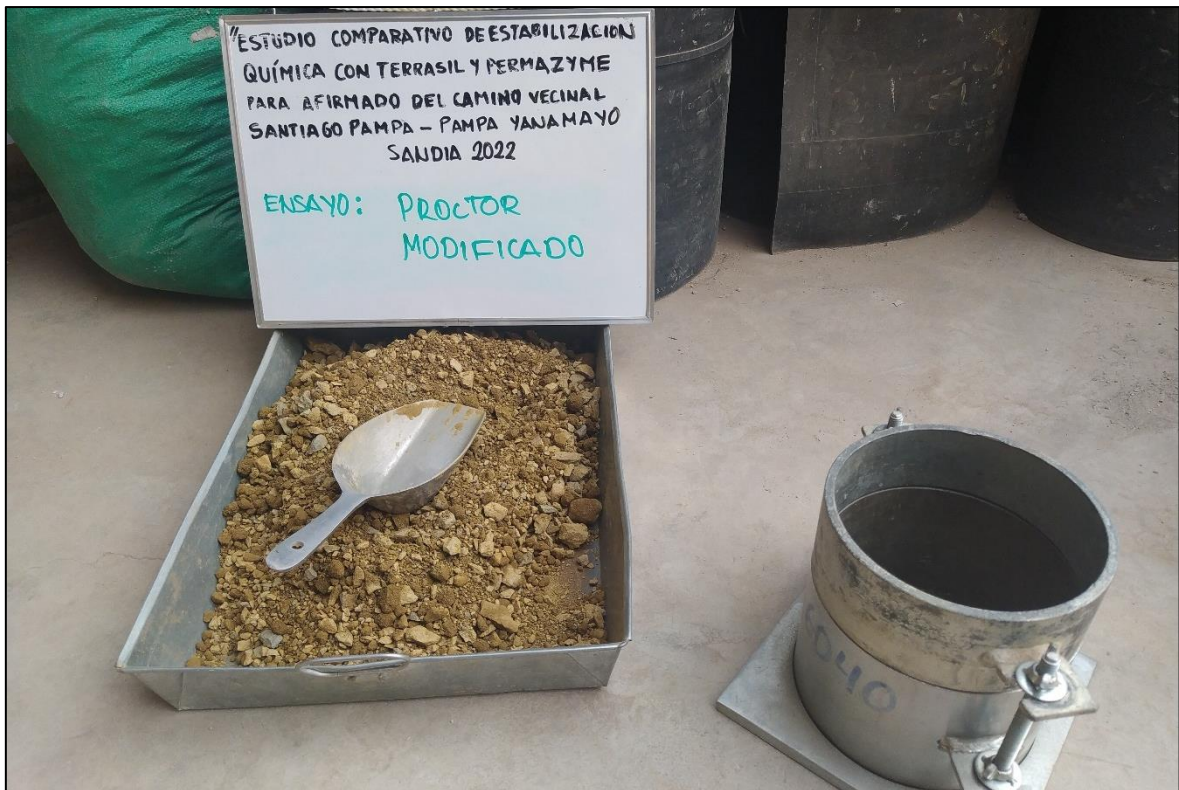
Fotografía 20. Material seleccionado para realizar el ensayo de Proctor modificado.
