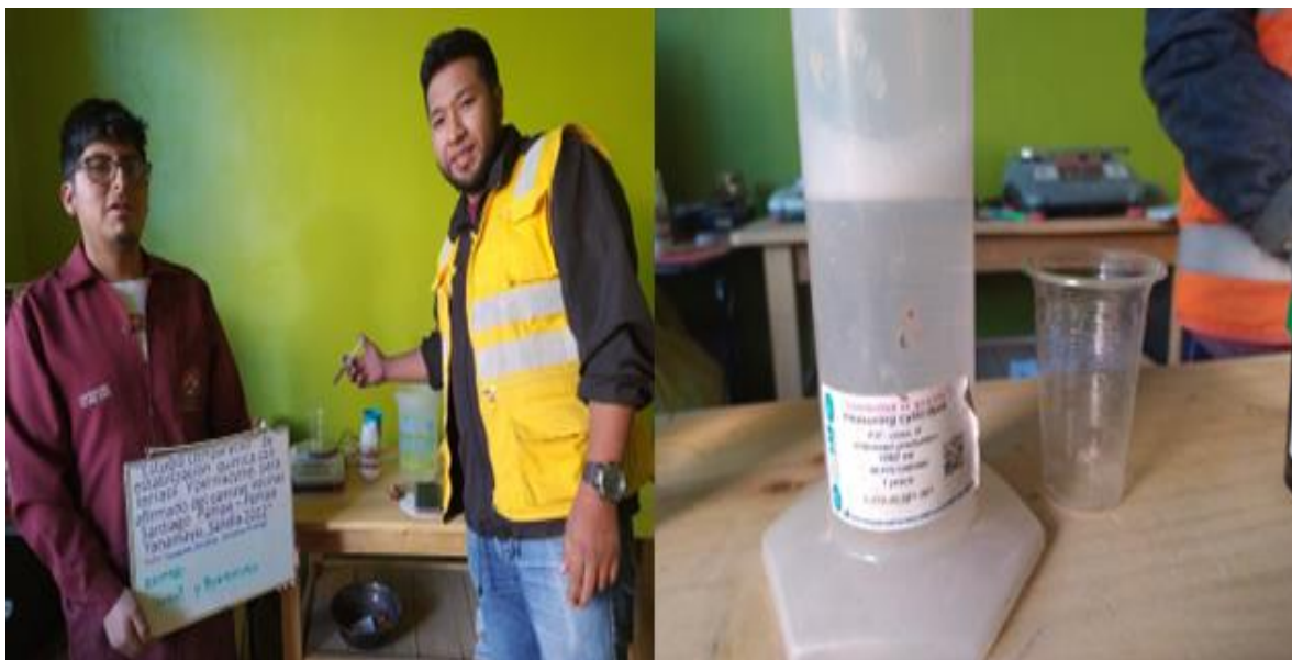
Fotografía 27. Se realiza el pesado de la dosificación calculado en base a la densidad máxima seca de la muestra patrón, esto para ambos aditivos.
