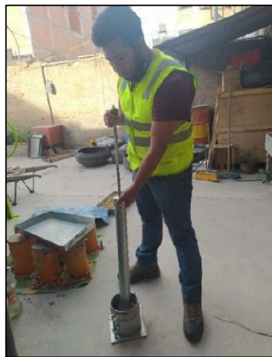
Imagen 24. Compactado de la muestra en el ensayo de Proctor modificado.
