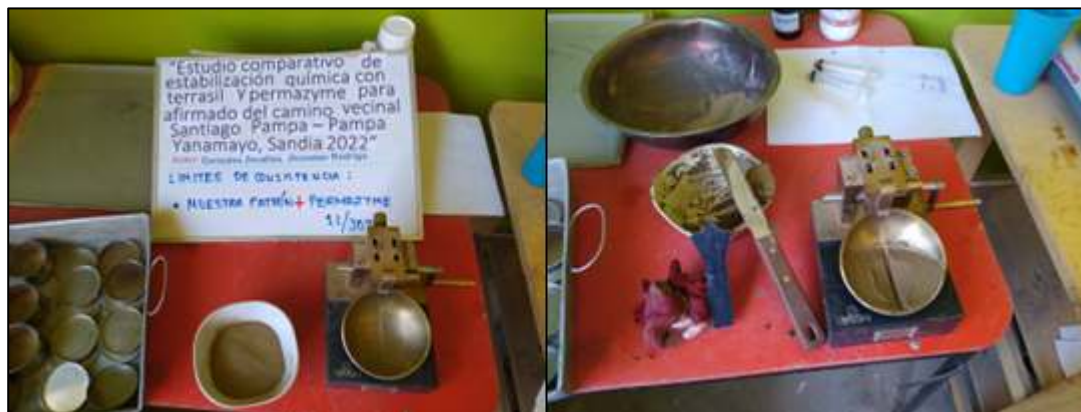
Imagen 50. Cuchara de Casagrande con el aditivo permazyme.
