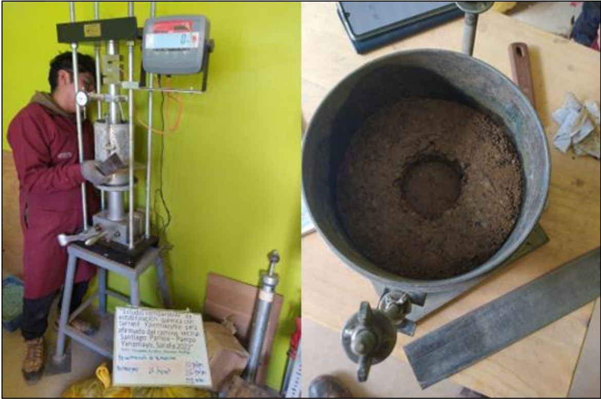
Fotografía 34. Penetración de la muestra con aditivo y se aprecia como quedó luego del proceso de penetración.
