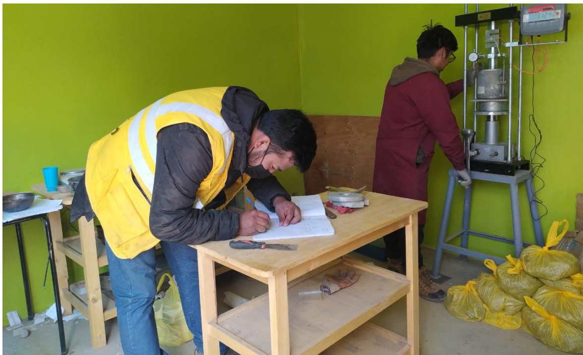
Fotografía 33. Se muestra la toma de los resultados por un periodo de tiempo para poder medir la capacidad de soporte de la muestra con aditivo terrasil y permazyme.
