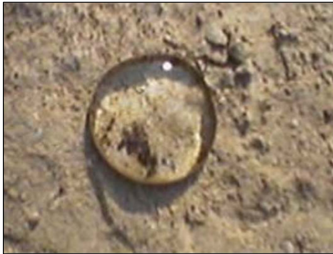
Imagen 9. Acción repelente del suelo. Tomado de la “ficha técnica del producto”, de BREM S.A.C, 2015. p. 2.
