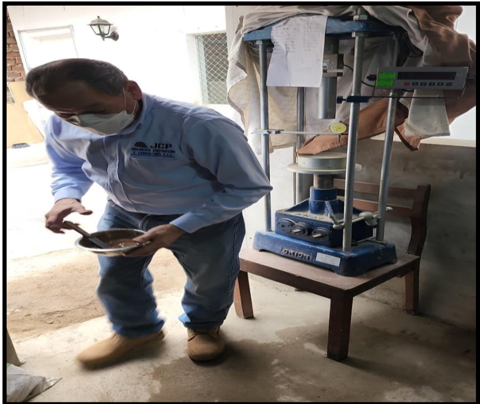
Ensayo de CBR
