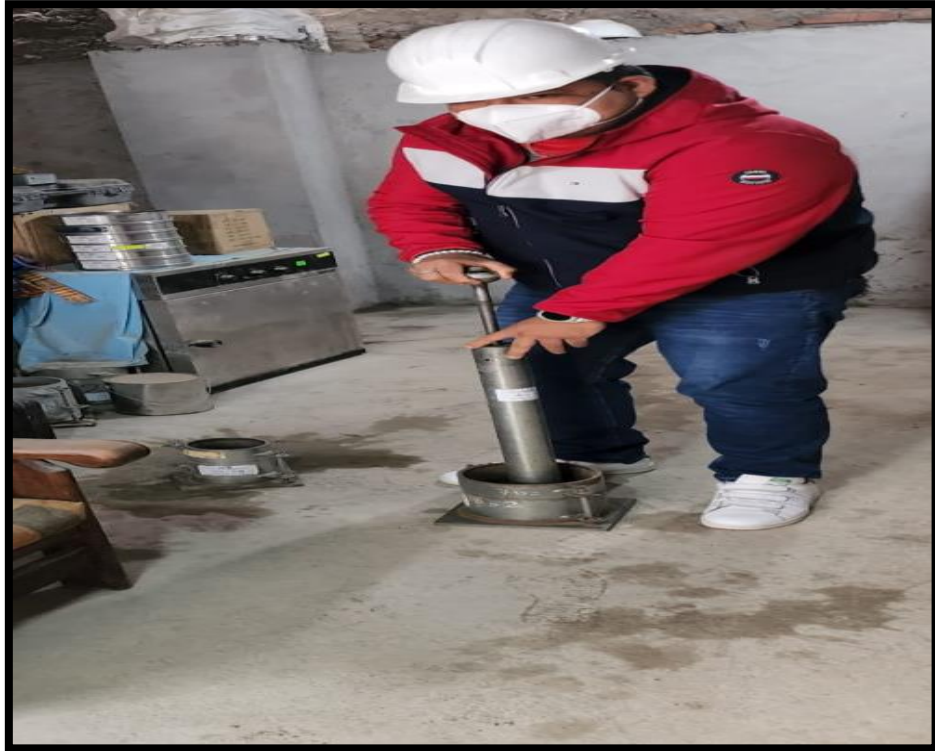
Ensayo de CBR
