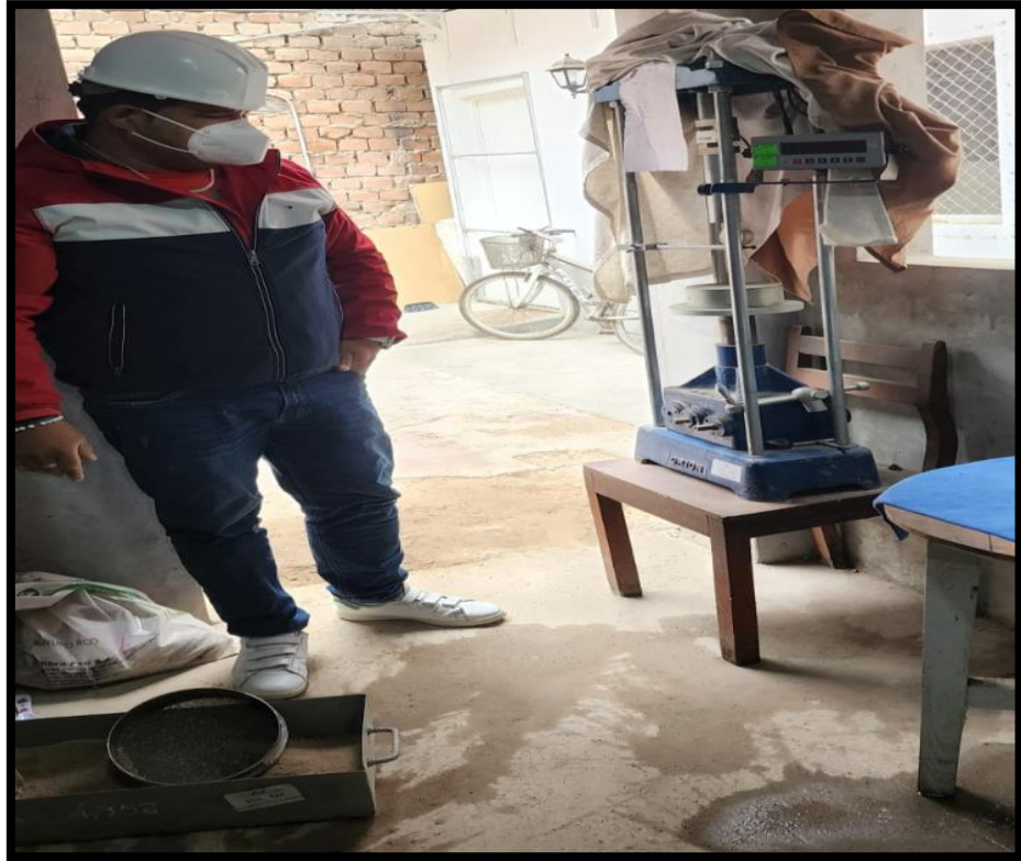
Ensayo de CBR
