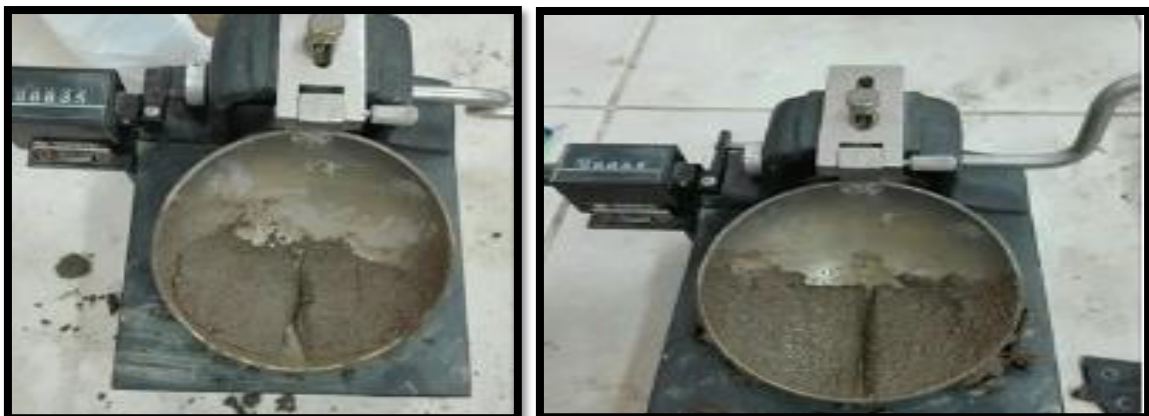
Imagen 11. Ensayo en la copa de casa grande
