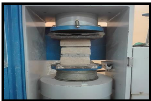
Imagen 27. Ensayo de pilas a compresión axial.
