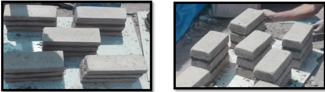
Imagen 16. Acopio de pilas con suelo cemento
