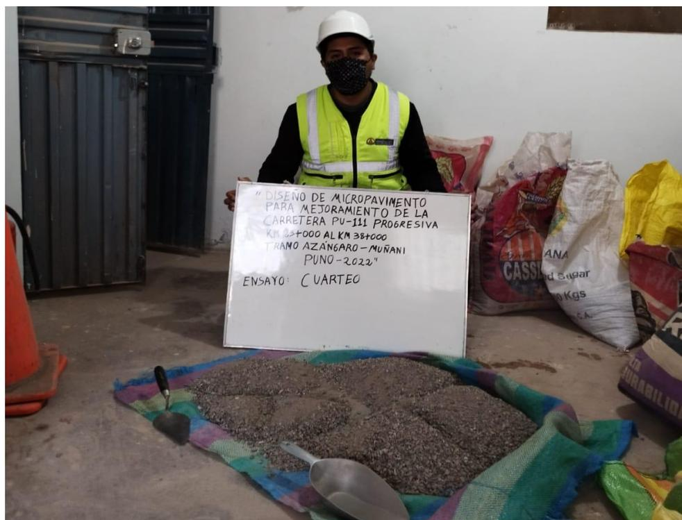
Figura 21. Proceso de cuarteo de la muestra (arena chancada).
