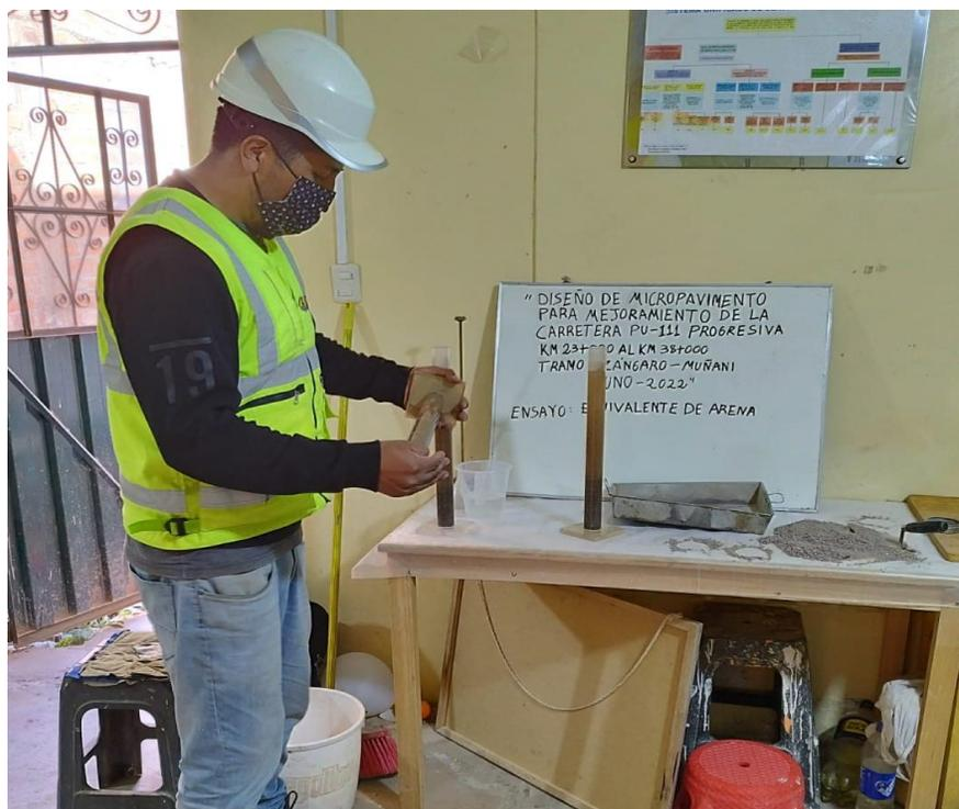
Figura 26. Proceso de agitación simultánea de la probeta graduada de plástico.
