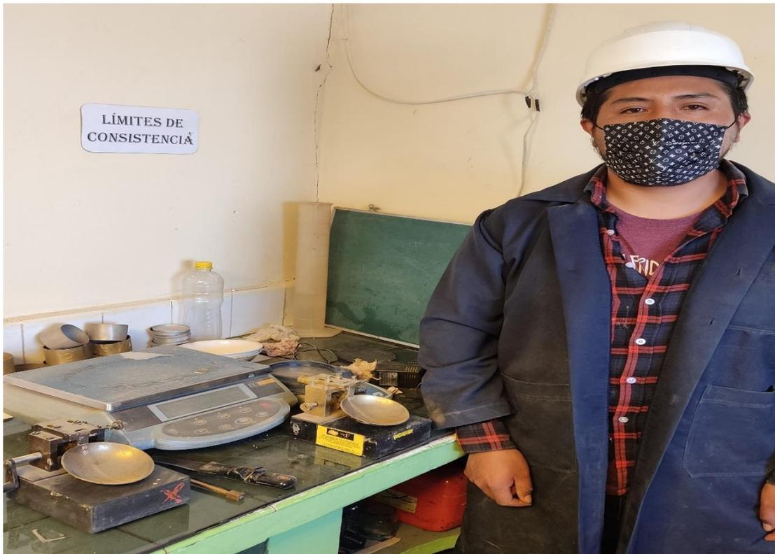
*Figura 10.* Aparatos para realizar los ensayos de límites de Atterberg.
