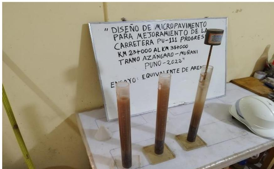
Figura 25. Colocación de la varilla lastrada con disco de asentamiento.
