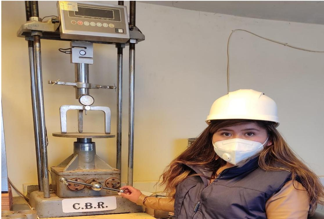
*Figura 11.* Prensa de carga CBR.
