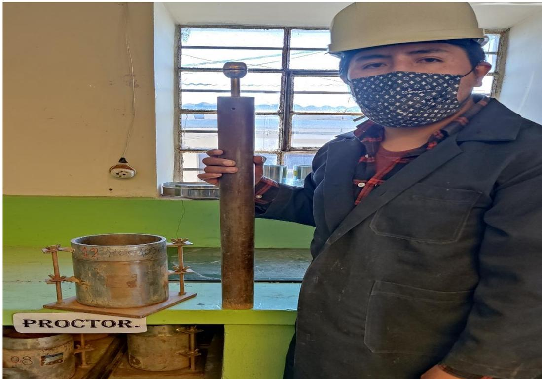
Figura 12. Molde para proctor y martillo compactador.
