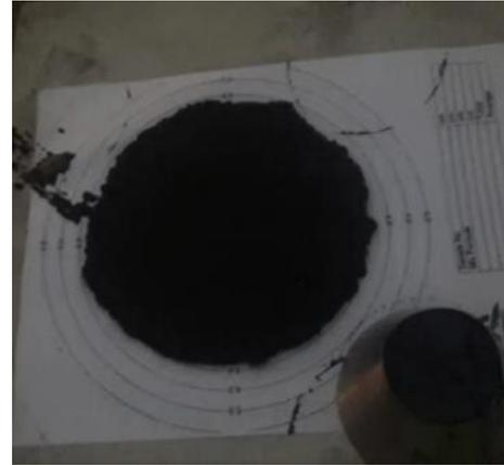
Figura 31. Retirado del cono de Kansas y lectura de la consistencia de la mezcla.
