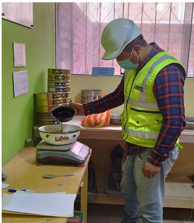
Figura 30. Adición de la emulsión asfáltica al recipiente.
