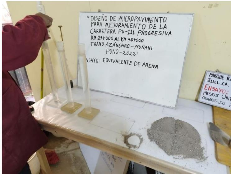
**Fotografía 05.** Ensayo equivalente de arena.
