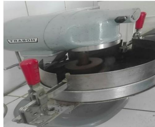
Figura 33. Maquina simulador de abrasión en húmedo.
