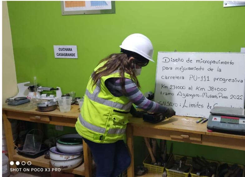
**Fotografía 03.** Ensayo de límite líquido.
