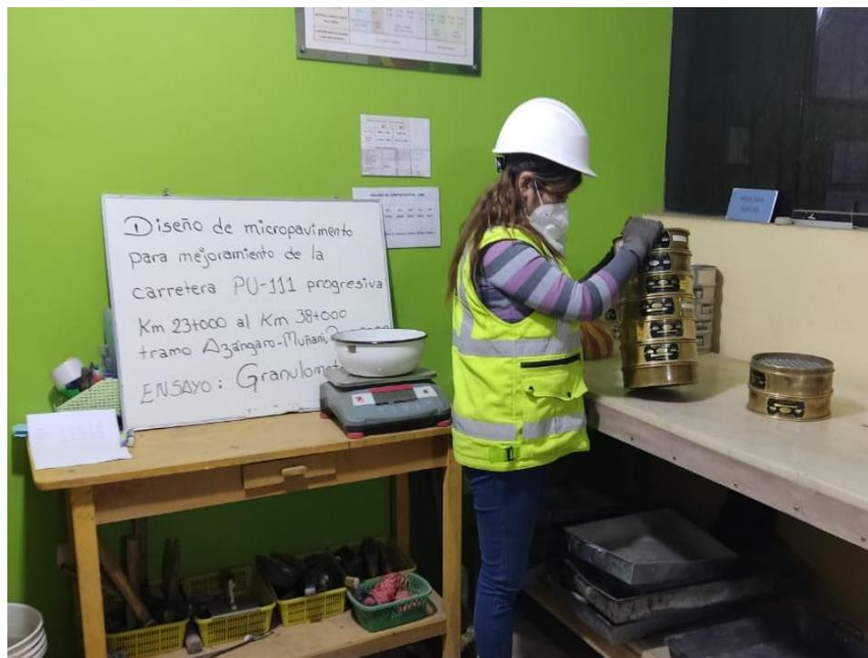
Figura 22. Proceso de zarandeo del agregado fino, pasante la malla N.º 4.
