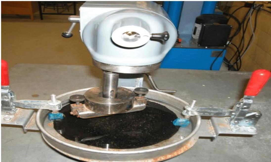
*Figura 18.* Máquina para ensayo de abrasión en húmedo.
