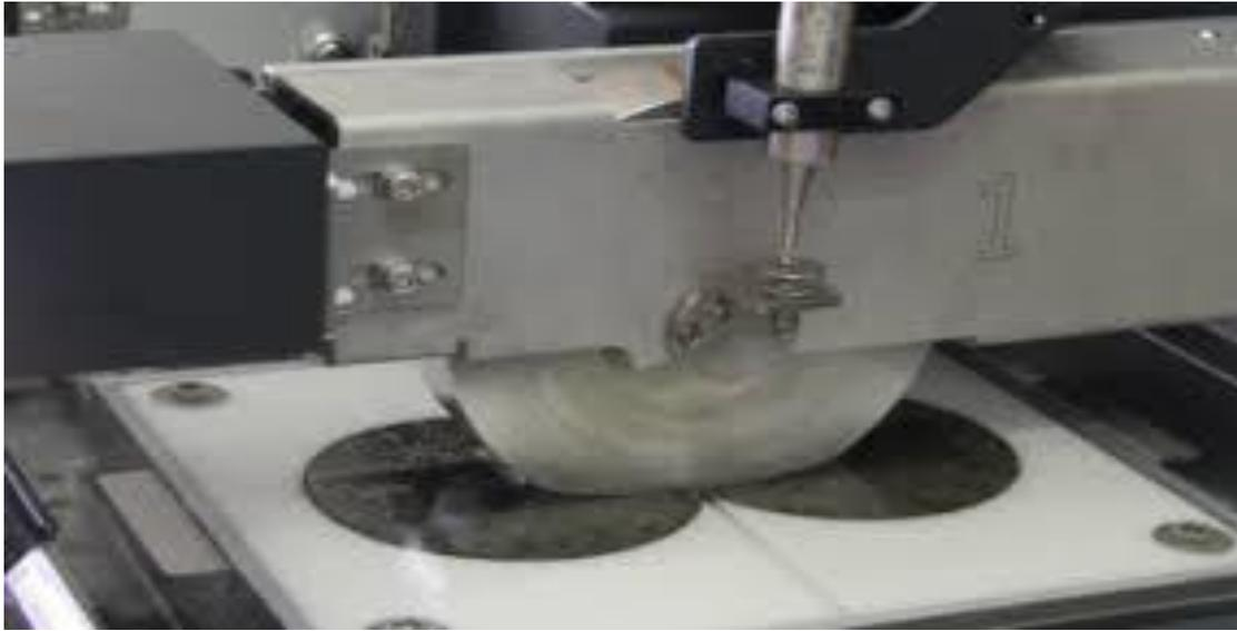
*Figura 19.* Máquina para ensayo de la rueda cargada.
