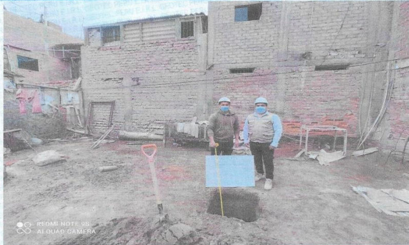
VISTA DE LA EXCAVACION DE LA CALICATA C-02 PRESENCIA DE NIVEL FREATICO A 0.65M EN EL LOTE P22 DE LA URB. EL ACERO
