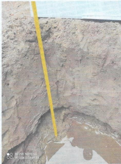
VISTA DE LA EXCAVACION DE LA CALICATA C-02 PRESENCIA DE NIVEL FREATICO A 0.65M EN EL LOTE P22 DE LA URB. EL ACERO
