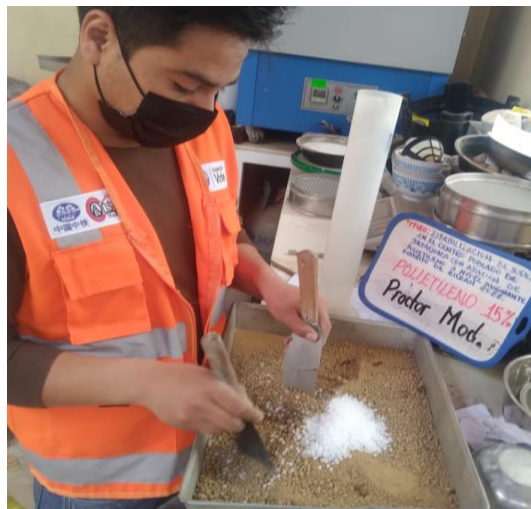
Figura 33 Compactado de CBR con 10% de polietileno.
