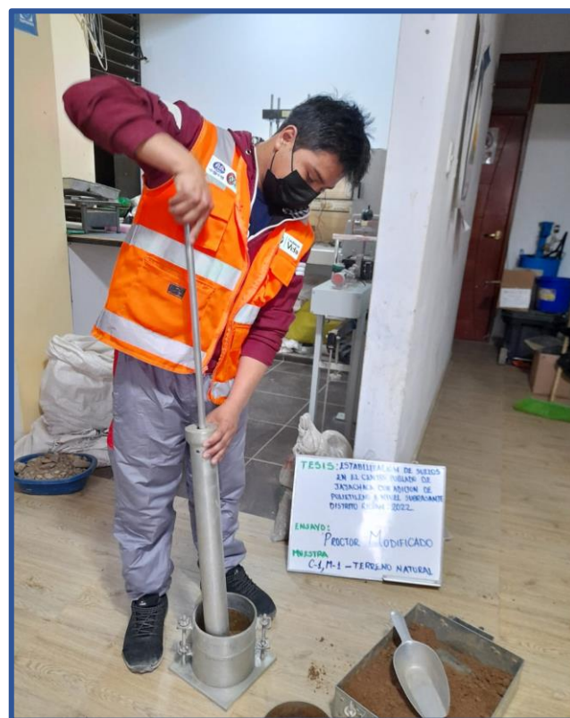
Figura 14: Ensayo de Proctor modificado estado natural
