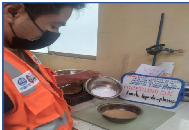
Figura 10: Ensayo de límites de plástico adición de 10% polietileno
