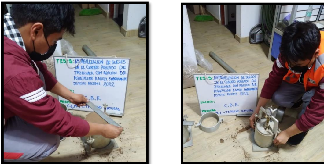
Figura 17 Ensayo de CBR del suelo natural.
