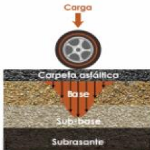
Figura 1 Estructura del paquete estructural del pavimento
