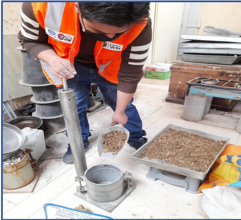
Figura 20: Ensayo de Proctor modificado compactado del material con 10% adición de polietileno
