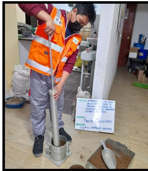
Figura 16 Ensayo de proctor modificado adicionando polietileno en 5% 10% y 15%.
