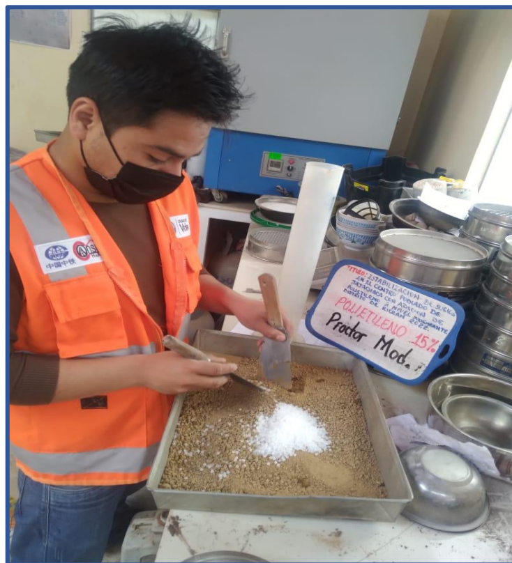
Figura 18: Ensayo de Proctor modificado con adición de 10% de polietileno
