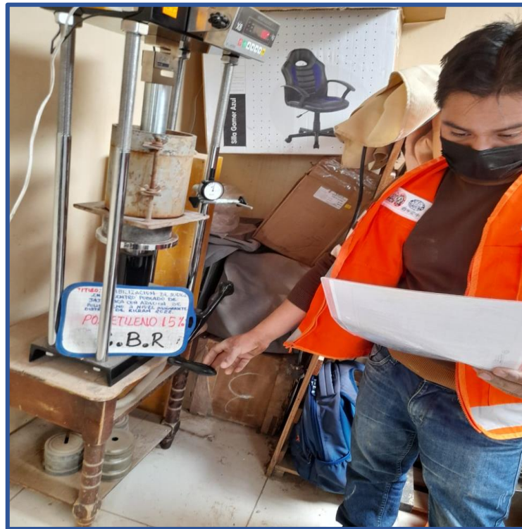
Figura 28: Ensayo de CBR al 15% de polietileno
