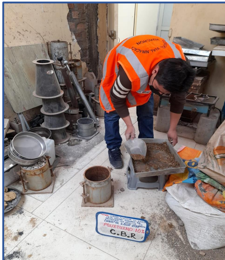
Figura 22: Ensayo de CBR compactado
