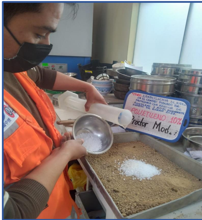
Figura 18: Ensayo de Proctor modificado con adición de 10% de polietileno
