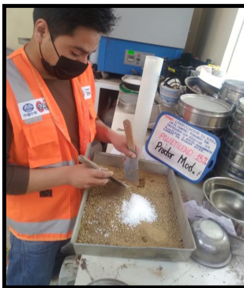
Figura 16 Ensayo de proctor modificado adicionando polietileno en 5% 10% y 15%.
