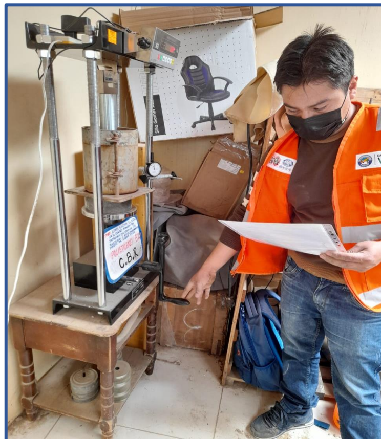
Figura 28: Ensayo de CBR al 15% de polietileno
