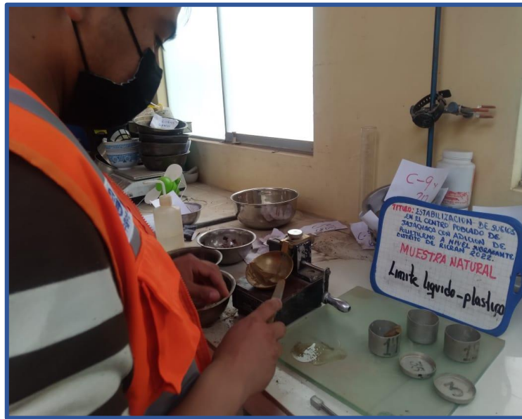
Figura 7: Ensayo de límites de plástico estado natural
