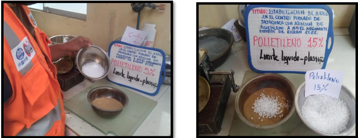
Figura 13 Ensayo de limite líquido y plástico con adición de polietileno granular.
