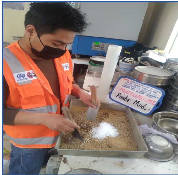
Figura 22: Ensayo de CBR compactado
