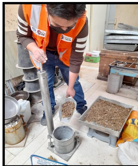
Figura 16 Ensayo de proctor modificado adicionando polietileno en 5% 10% y 15%.
