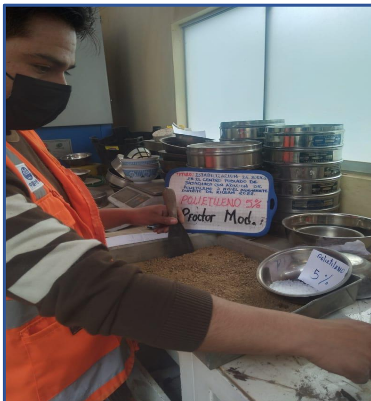
Figura 16: Ensayo de Proctor modificado con adición de 5% de polietileno
