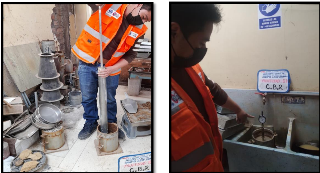
Figura 18 Ensayo de CBR adicionando polietileno en 5%,10% y 15%.
