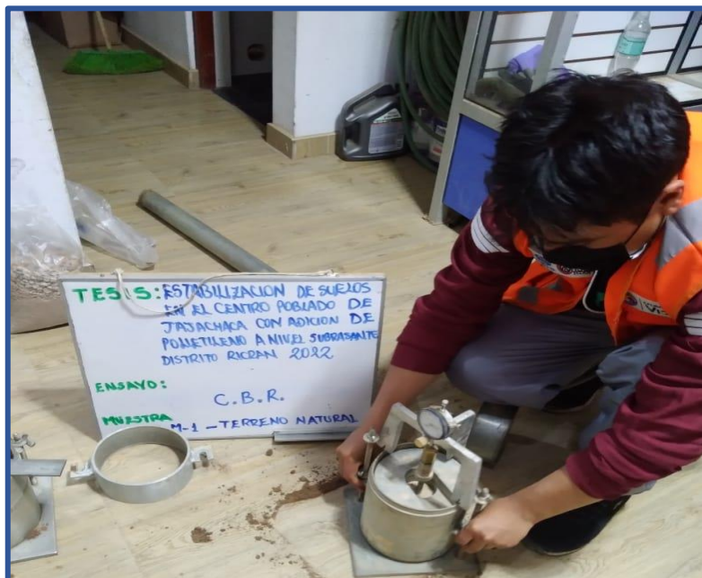
Figura 24: Ensayo de CBR medición de la expansión
