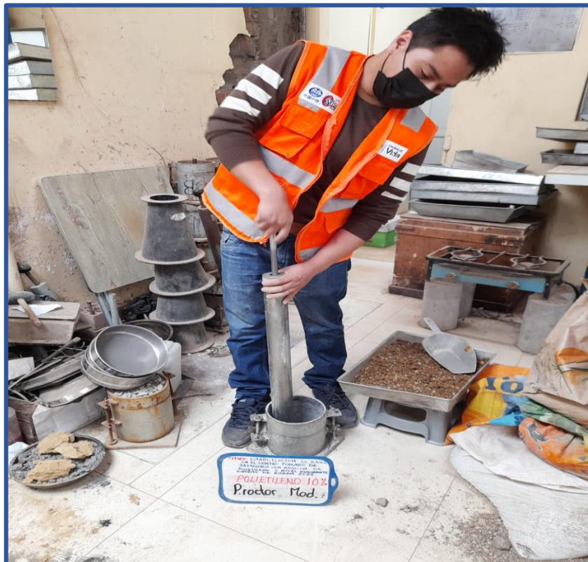
Figura 20: Ensayo de Proctor modificado compactado del material con 10% adición de polietileno
