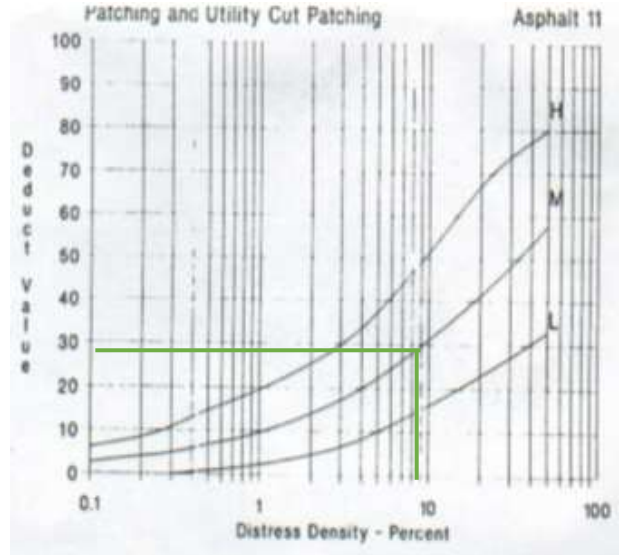
Parqueo y acometidas de servicio (M)
