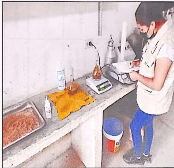
Método de ensayo normalizado para la densidad, la densidad relativa (peso específico) y absorción del agregado fino NTP 400.022 – 2013.
