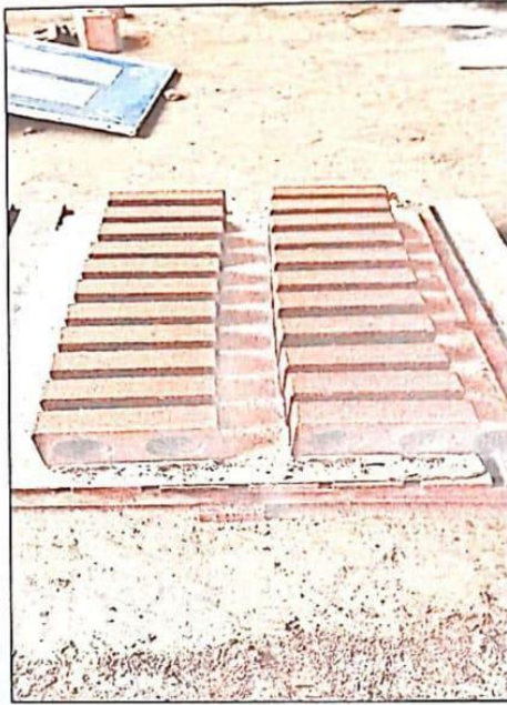
Proceso de curado de ecoladrillos, moldeo patrón y las distintas respectivas adiciones.
