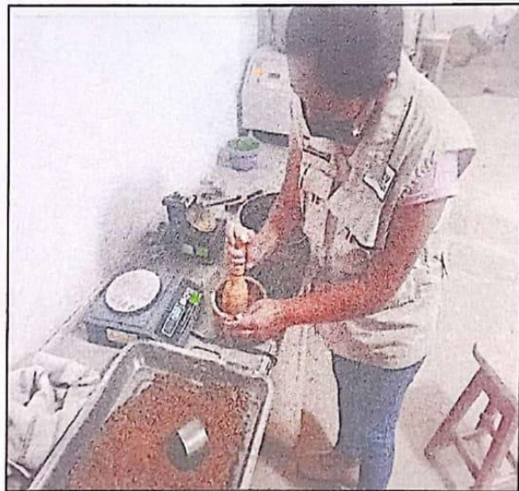
Proceso de tamizado por el tamiz N° 40 para la preparación de muestra para en el ensayo de limite líquido y limite plástico.
