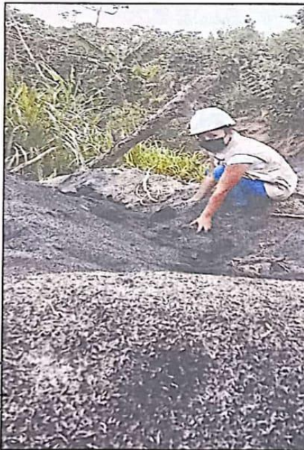
Proceso de calcinación de la cascarilla de arroz en un lugar abierto en la molinera san Felipe en la ciudad de Moyobamba.
