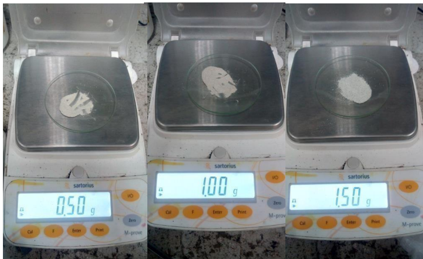
Figura 15: Pesaje de cascara de codorniz ( Coturnix coturnix ) en malla N° 80 pesando a las dosis respectivas
