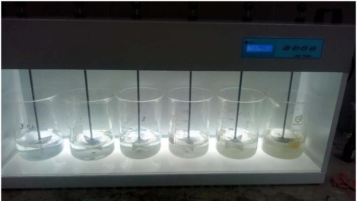
Figura 16: la prueba de jarras utilizando las cascara de codorniz ( Coturnix coturnix )
