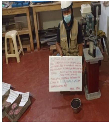
Figura 45. Muestra del asfalto con 3%+5%, 4%+10% y 5%+15% de caucho y tubería PVC Fuente: Elaboración propia
