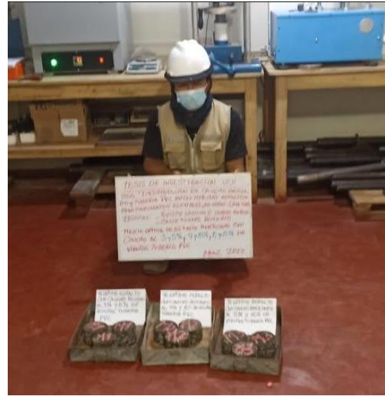
Figura 36. Muestra de las briquetas de asfalto 3%+5%, 4%+10% y 5%+15% de caucho y tubería PVC
