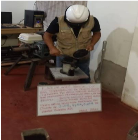
Figura 44. Mezcla del cemento asfáltico de caucho y tubería PVC Fuente: Elaboración propia
