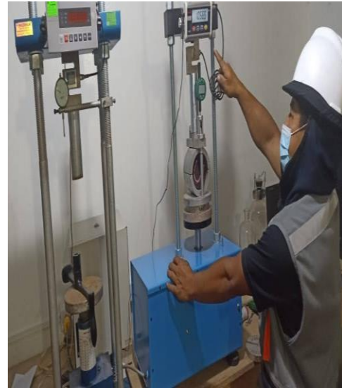
Figura 42. Valor de la muestra del ensayo Marshall para determinar la estabilidad.
