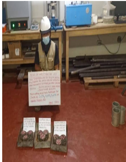
Briquetas con caucho y pvc (3%+5%, 4%+10% y 5%+15%)
