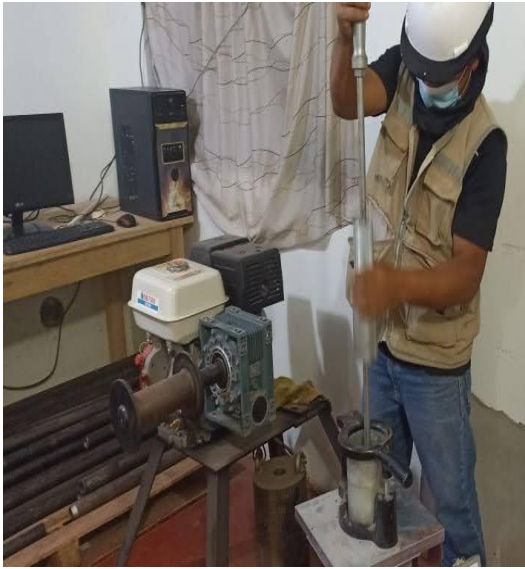
Figura 35. Elaboración y compactación de la briqueta de asfalto con 3%+5%, 4%+10% y 5%+15% de caucho y tubería PVC
