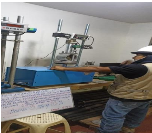
Figura 46. Preparación de las muestras para el ensayo Marshall para determinar el flujo. Fuente: Elaboración propia
