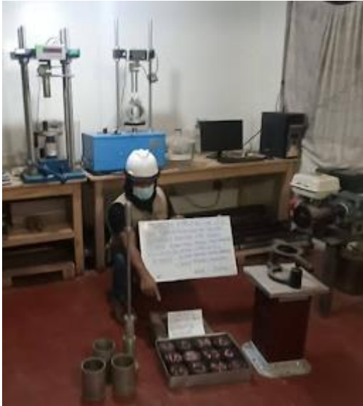
Desmolde de las briquetas
