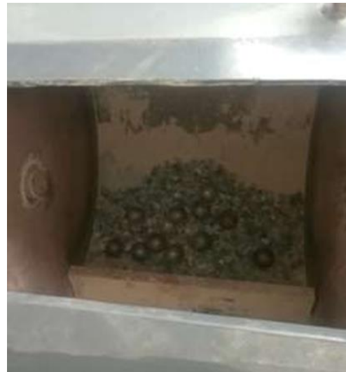
Colocación en la Máquina Los Ángeles
