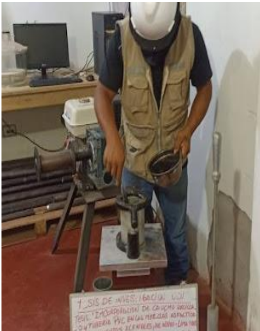
Llenado de asfalto al recipiente
