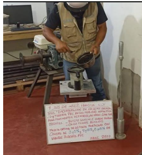
Figura 34. Mezcla del cemento asfáltico de caucho y tubería PVC
