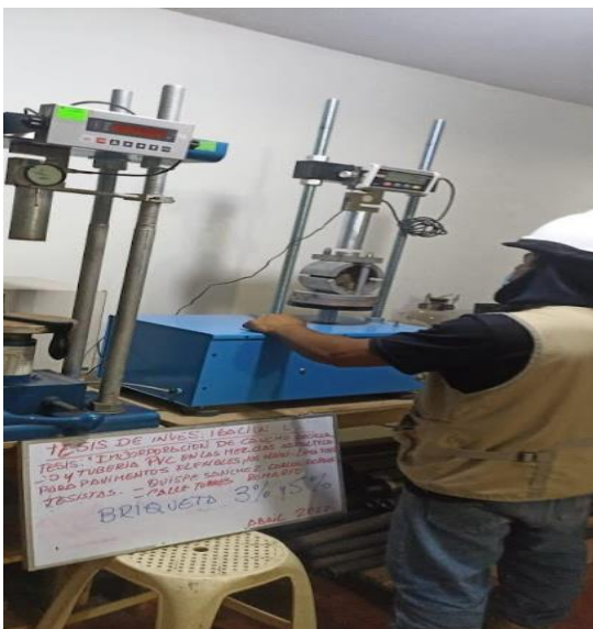
Figura 37. Preparación de las muestras para el ensayo Marshall para determinar el flujo.
