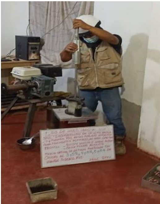
Compactación de 75 golpes por cara
