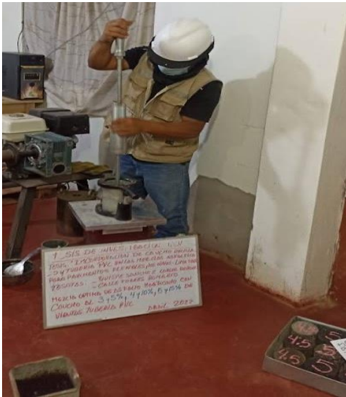
Figura 39. Elaboración y compactación de la briqueta de asfalto con 3%+5%, 4%+10% y 5%+15% de caucho y tubería PVC
