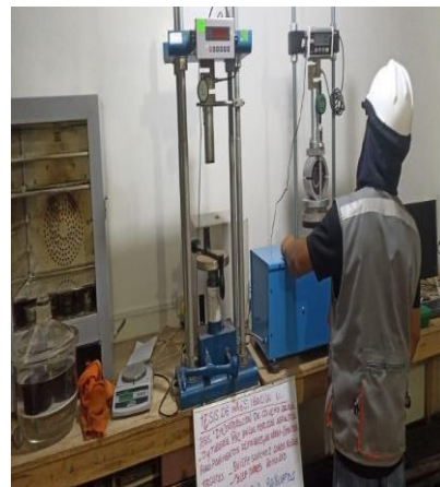
Figura 47. Valor de la muestra del ensayo Marshall para determinar el flujo. Fuente: Elaboración propia
