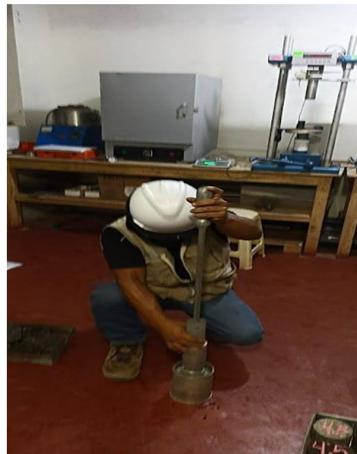
Compactación de 75 golpes por cara
