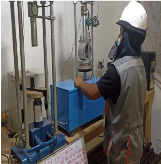
Figura 41. Preparación de las muestras para el ensayo Marshall para determinar la estabilidad.
