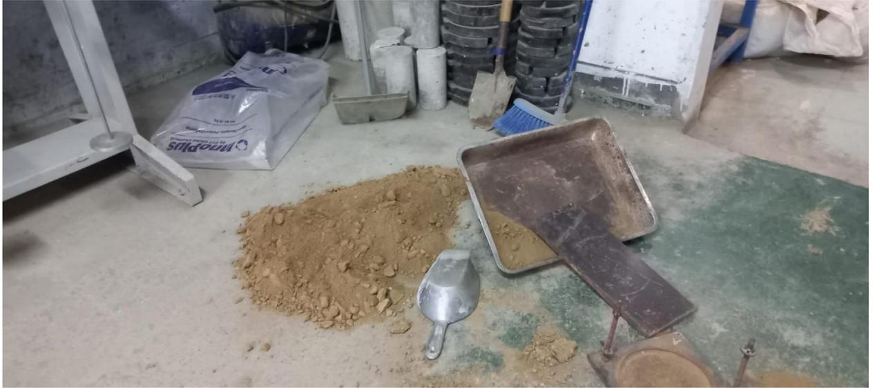
HUMEDECER PARA LAVADO Y SECADO DE MUESTRA EN HORNO A 110°
