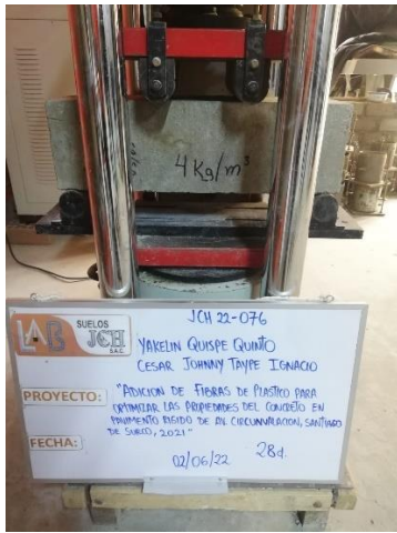
Figura 26. Ensayo de resistencia a la Flexion – 28 días
