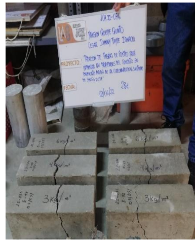
Figura 27. Vigas ensayadas a los 28 días
