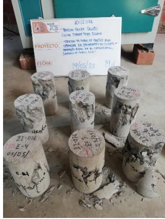
Figura 19. Probetas ensayadas – 14 días
