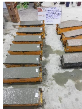
Figura 12. Vaciado de concreto en vigas
