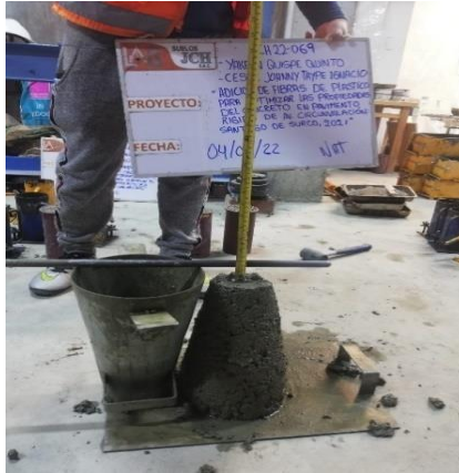
Figura 7. Medición del asentamiento de concreto
