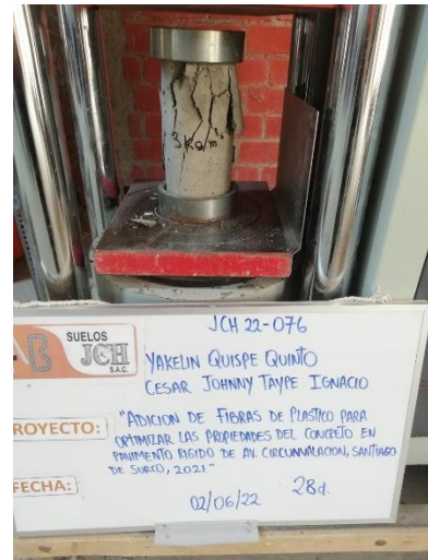
Figura 21. Probeta ensayada a los 28 días
