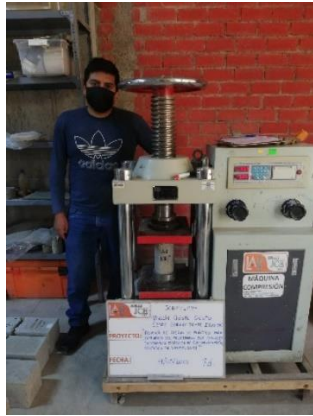
Figura 13. Maquina para realizar ensayo de compresion
