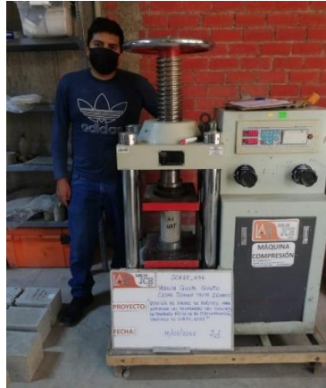
Figura 14. Ensayo de resistencia a la compresión – 7 días
