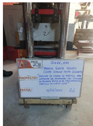
Figura 16. Viga en maquina antes de ser ensayada - 7 días
