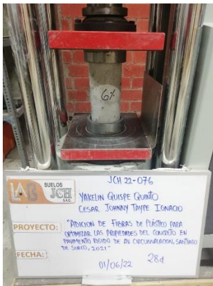
Figura 21. Probeta en maquina antes de ser ensayada – 28 días
