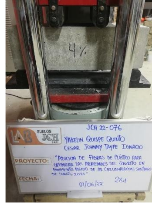
Figura 20. Viga en maquina a antes de ser ensayada – 28 días
