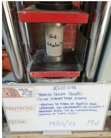
Figura 17. Ensayo de resistencia a la Compresion – 14 días
