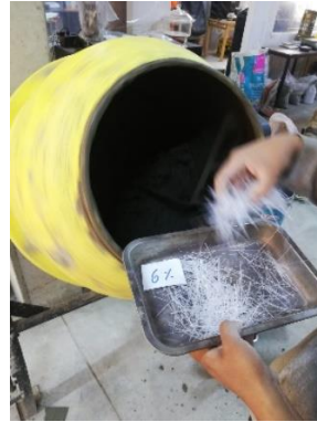
Figura 7. Incorporación de polipropileno en concreto
