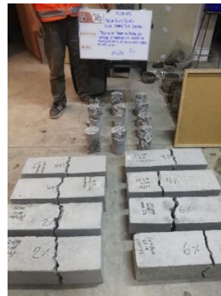
Figura 22. Probetas y vigas ensayadas – 28 días
