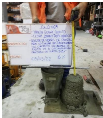
Figura 12. Ensayo de asentamiento de concreto
