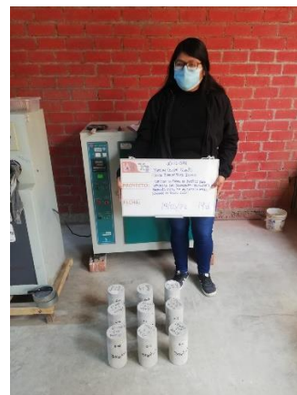
Figura 18. Probetas de concreto antes de ser ensayadas – 14 días
