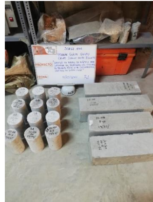
Figura 14. Probetas y vigas antes de ser ensayadas – 7 días
