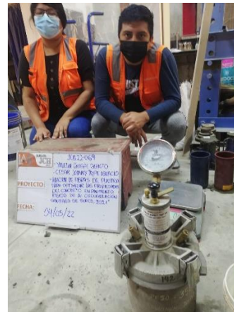
Figura 9. Ensayo de contenido de aire
