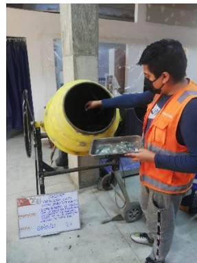
Figura 6. Incorporación de fibra PET en concreto
