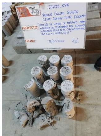
Figura 15. Probetas de concreto ensayadas – 7 días
