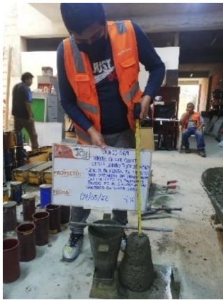
Figura 8. Ensayo de asentamiento
