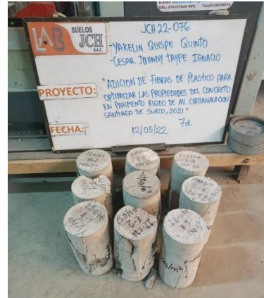
Figura 15. Probetas ensayadas a los 7 días
