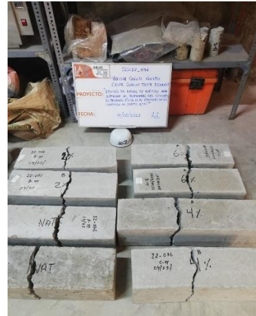
Figura 24. Viga ensayada a los 7 días
