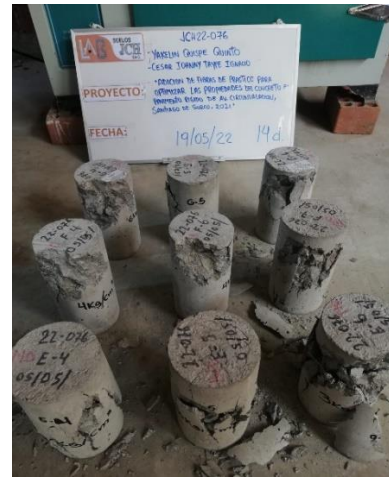
Figura 18. Probetas ensayadas a los 14 días
