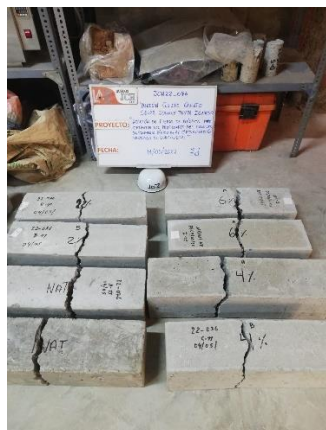
Figura 17. Vigas de concreto ensayadas – 7 días
