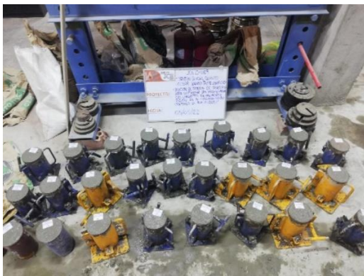
Figura 10. Vaciado de concreto en probetas
