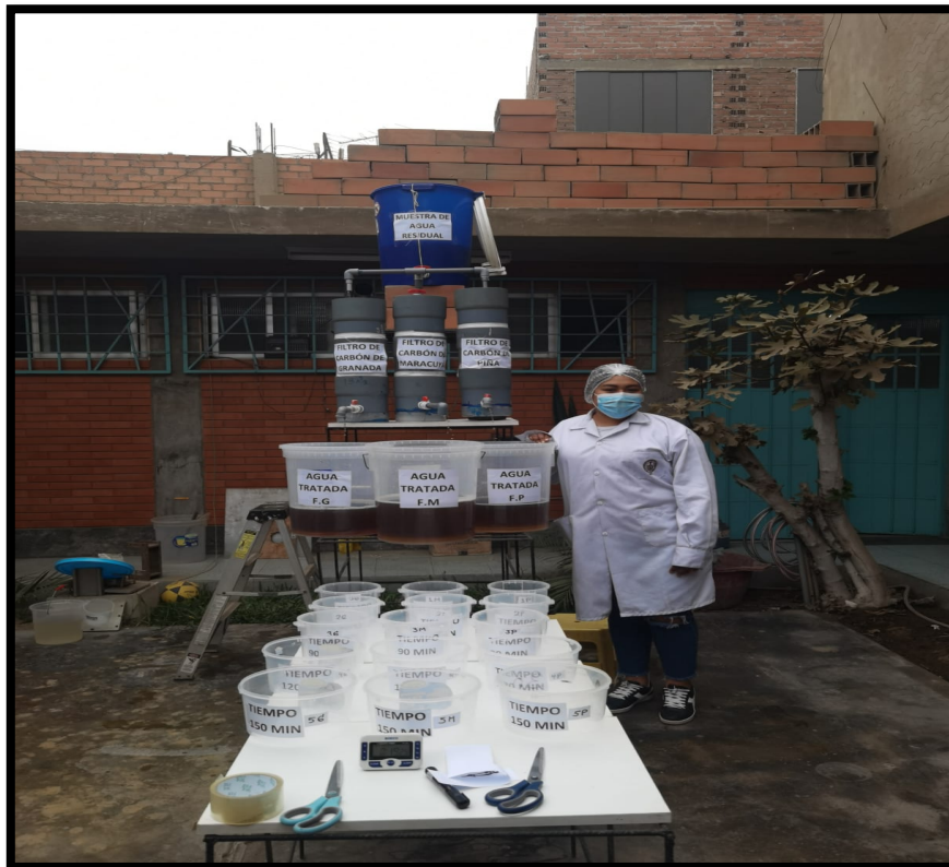
Imagen con el filtro de aguas negras con el biocarbón
