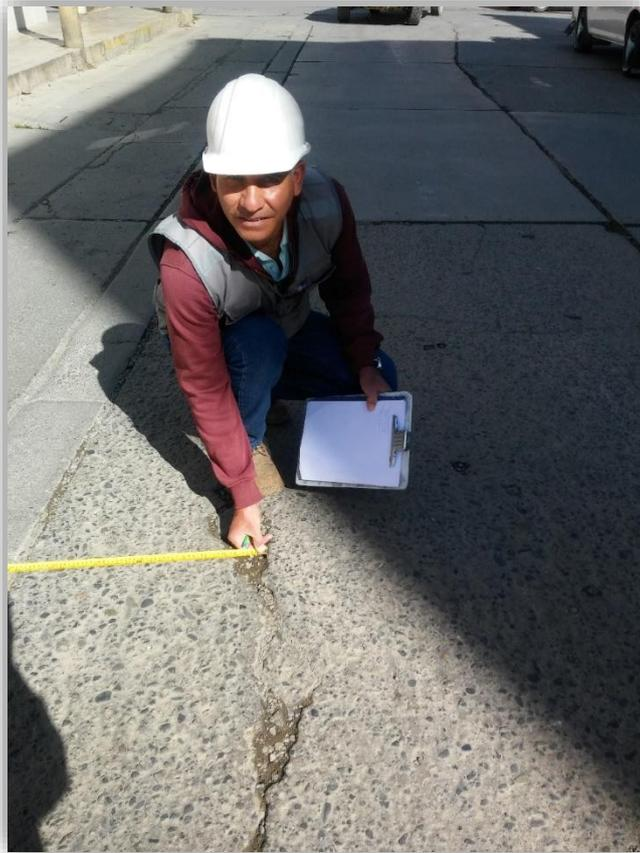
Foto de la Evaluación de las fallas del pavimento rígido
