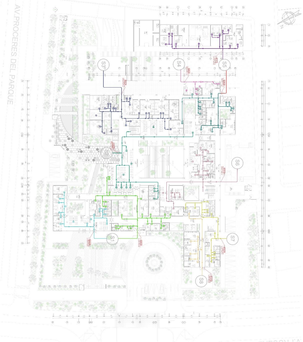
PLANTA DE EVACUACION - PRIMER PISO ESCALA 1:200
