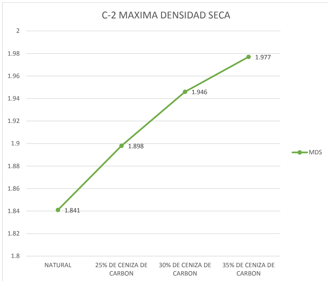
Figura 35 Proctor modificado C-2 prog 0+360 adicionado ceniza de carbón.
