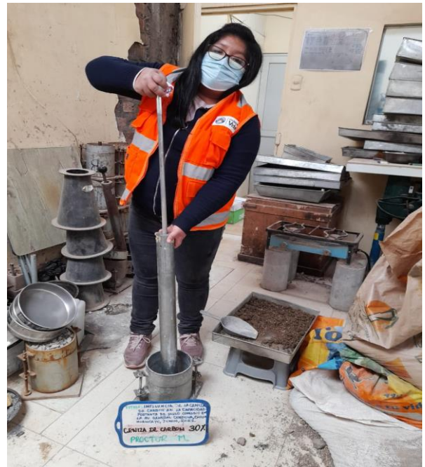
Compactado de proctor modificado con adición del 30% de ceniza de carbón.
