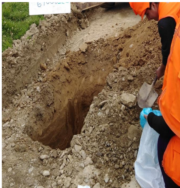
Recojo de la muestra de la excavación de la calicata C-1 de la progresiva 0+210
