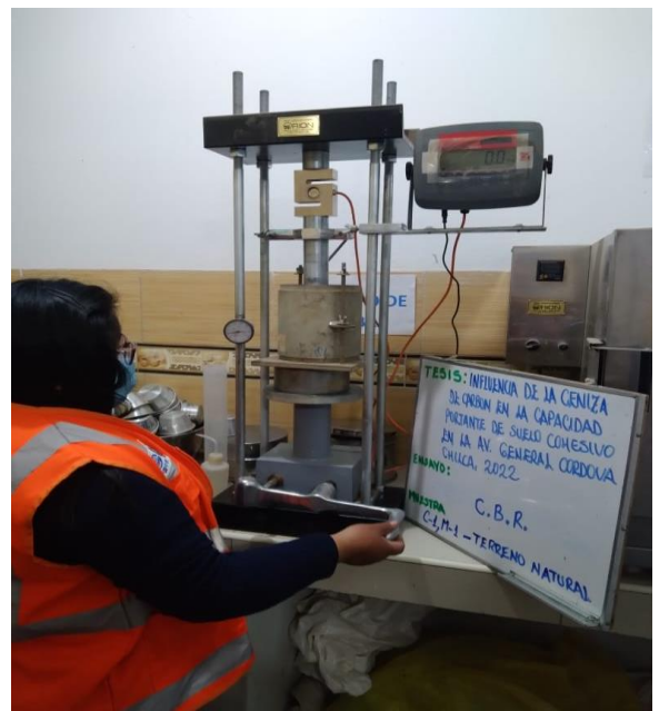
Rotura y lectura de los CBR compactados.
