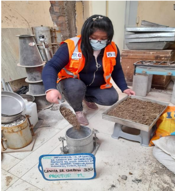
Muestra para la compactación de proctor con adición del 35% de ceniza de carbón.
