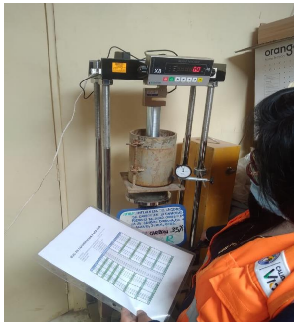
Rotura de CBR al con el 35% de adición de ceniza de carbón.
