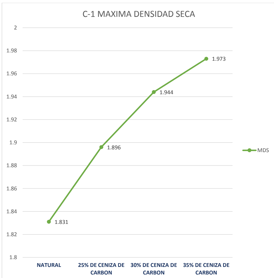
Figura 34 Proctor modificado C-1 prog 0+210 adicionado ceniza de carbón.
