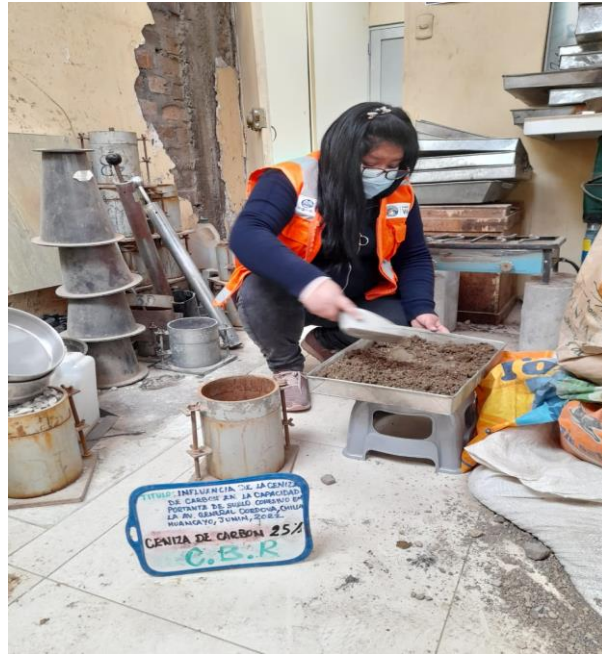
Compactación del CBR con adición de ceniza de carbón al 25%
