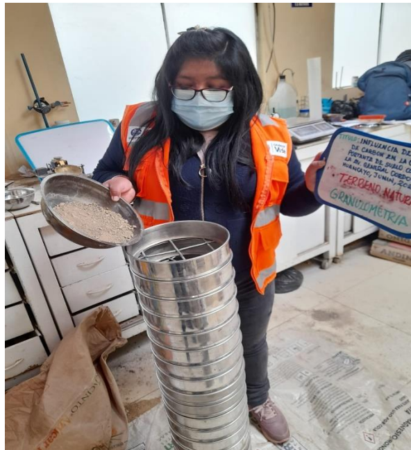
Tamizado del suelo natural para su clasificación.
