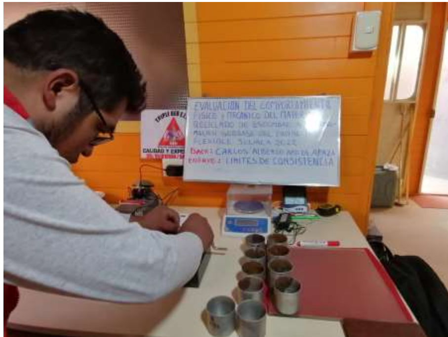
Figura 23. Ensayo de Limite líquido e IP.
