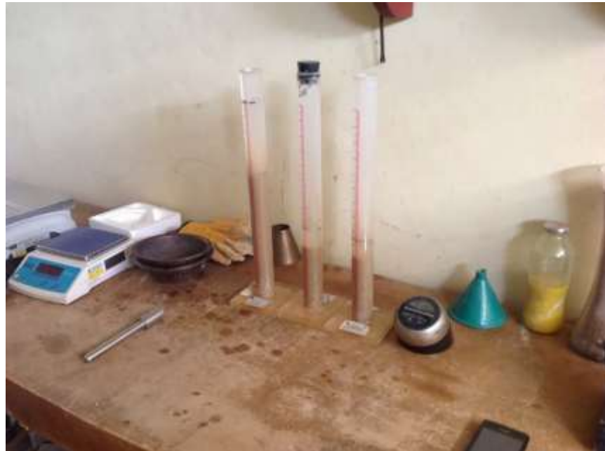
Figura 25. Ensayo de Equivalente de Arena.
