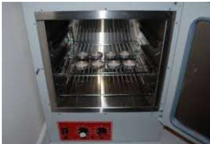
Figura 20. Ensayo de Contenido de humedad.
