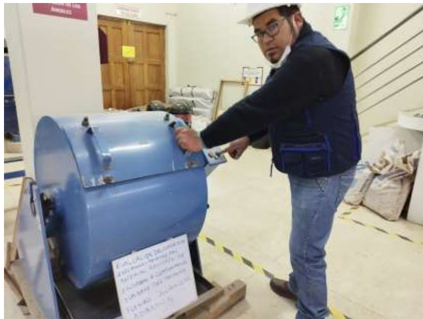
Figura 22. Ensayo de Abrasión los ángeles.
