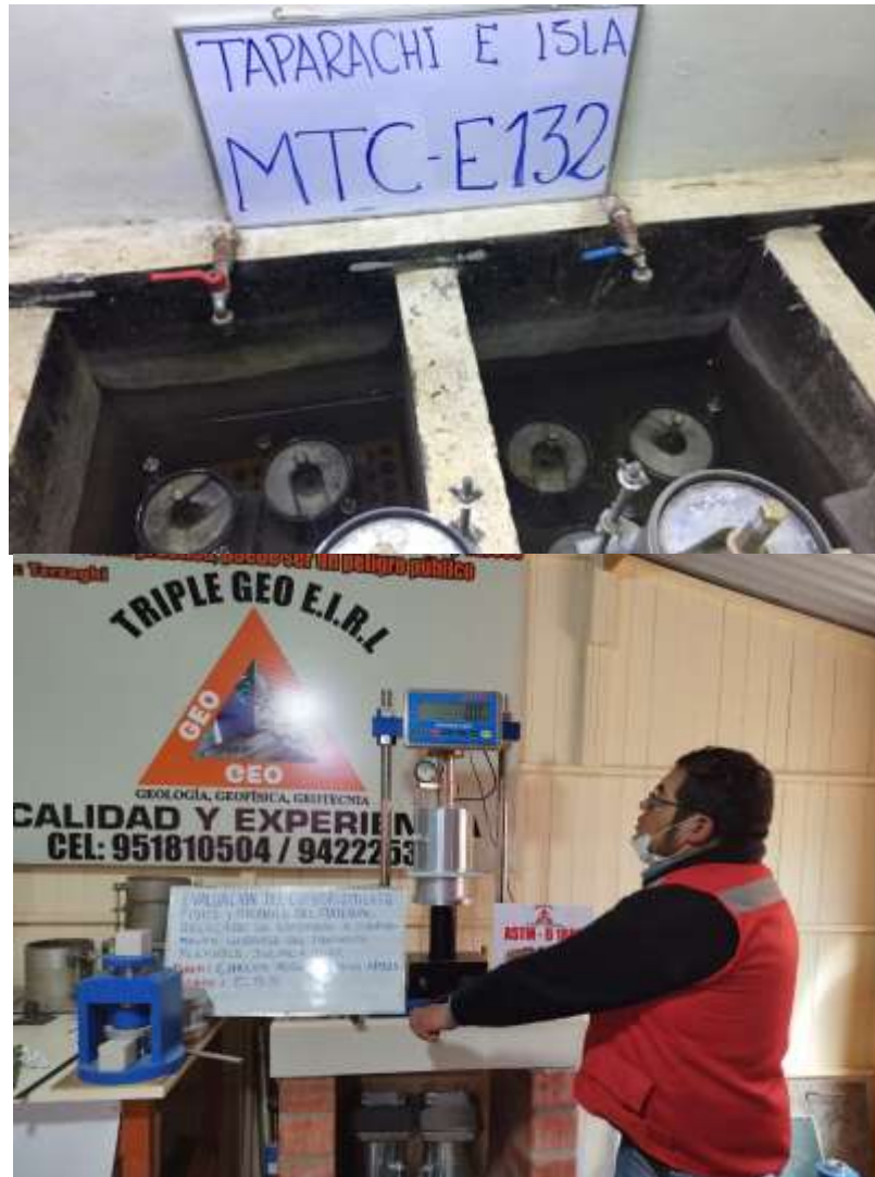
Figura 28. Ensayo de CBR.
