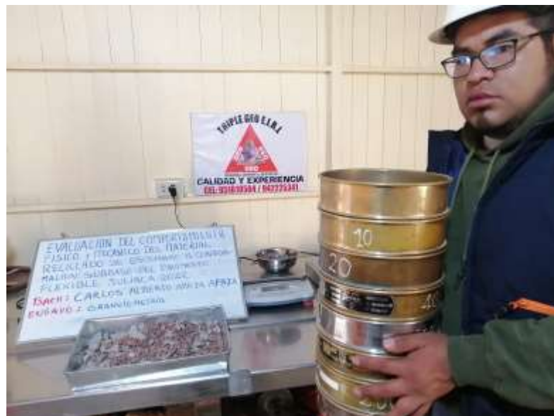
Figura 21. Ensayo de Análisis granulométrico.
