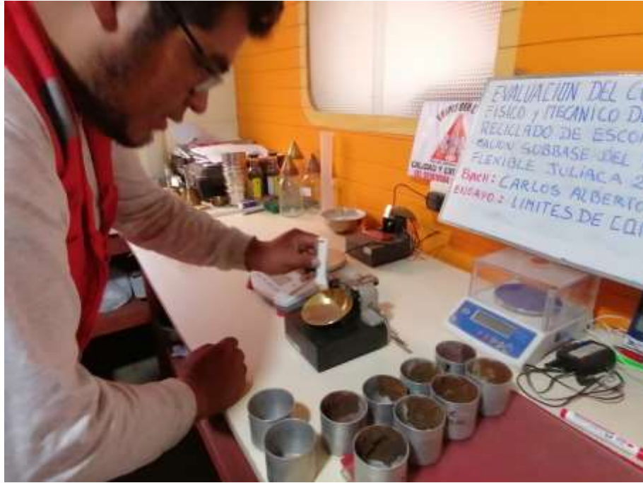
Figura 24. Ensayo de Limite líquido e IP.
