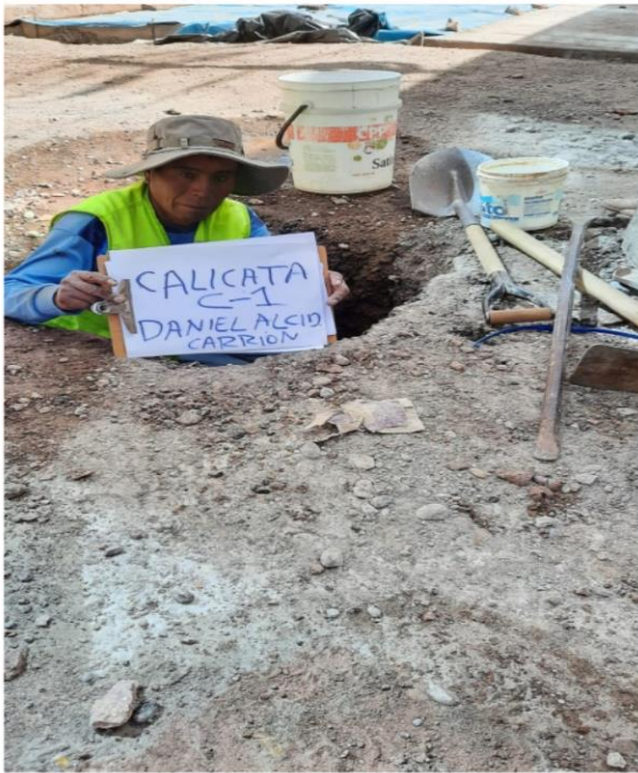
Gráfico N°02. Extracción de muestra de suelo, calicata 1
