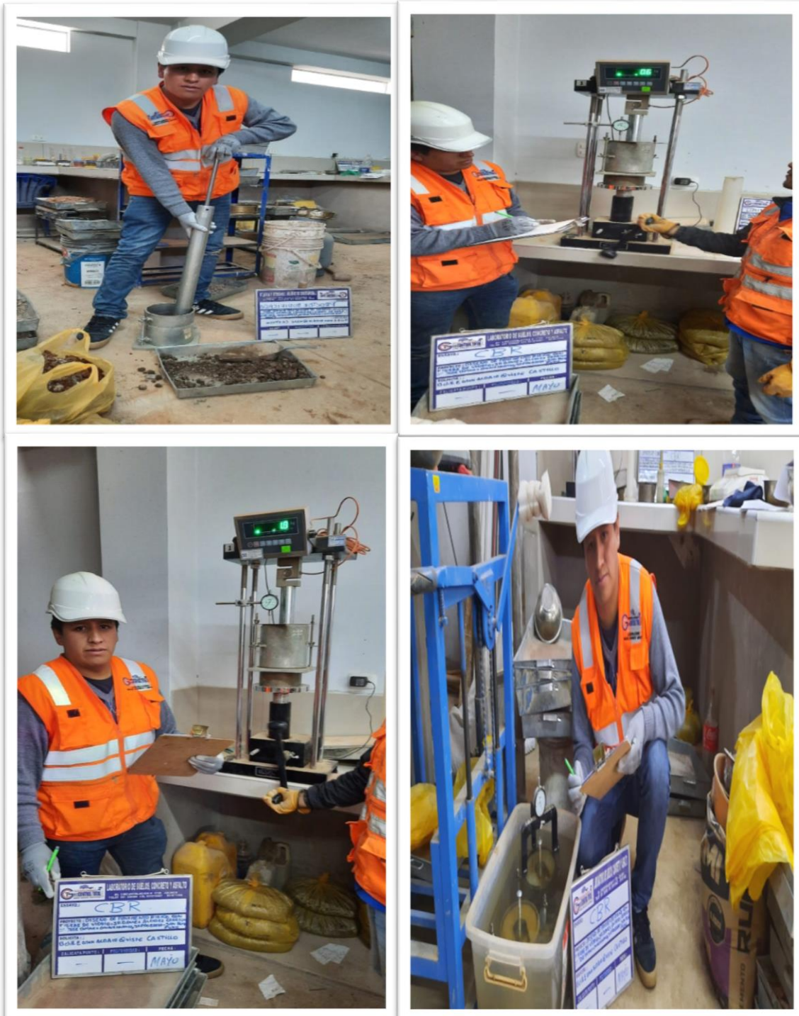
Gráfico N°04. Ensayos de laboratorio de suelos (Proctor modificado y CBR)
