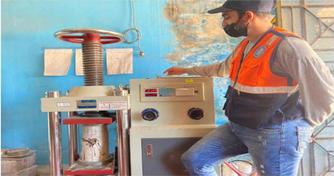
FOTO N°03: SE OBSERVA LA FALLA DEL TESTIGO DE CONCRETO DEL ENSAYO DE RESISTENCIA A LA COMPRESION (7 DIAS).
