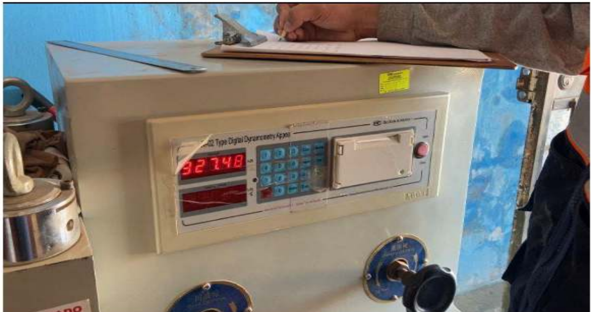
FOTO N°04: SE OBSERVA EL RESULTADO DE LA FALLA DEL TESTIGO DE CONCRETO (7 DIAS).
