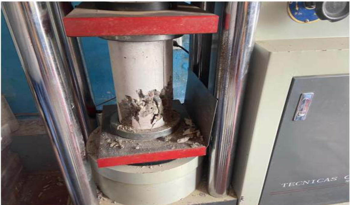
FOTO N°06: SE OBSERVA LA FALLA DEL TESTIGO DE CONCRETO DEL ENSAYO DE RESISTENCIA A LA COMPRESION. (14 DIAS)
