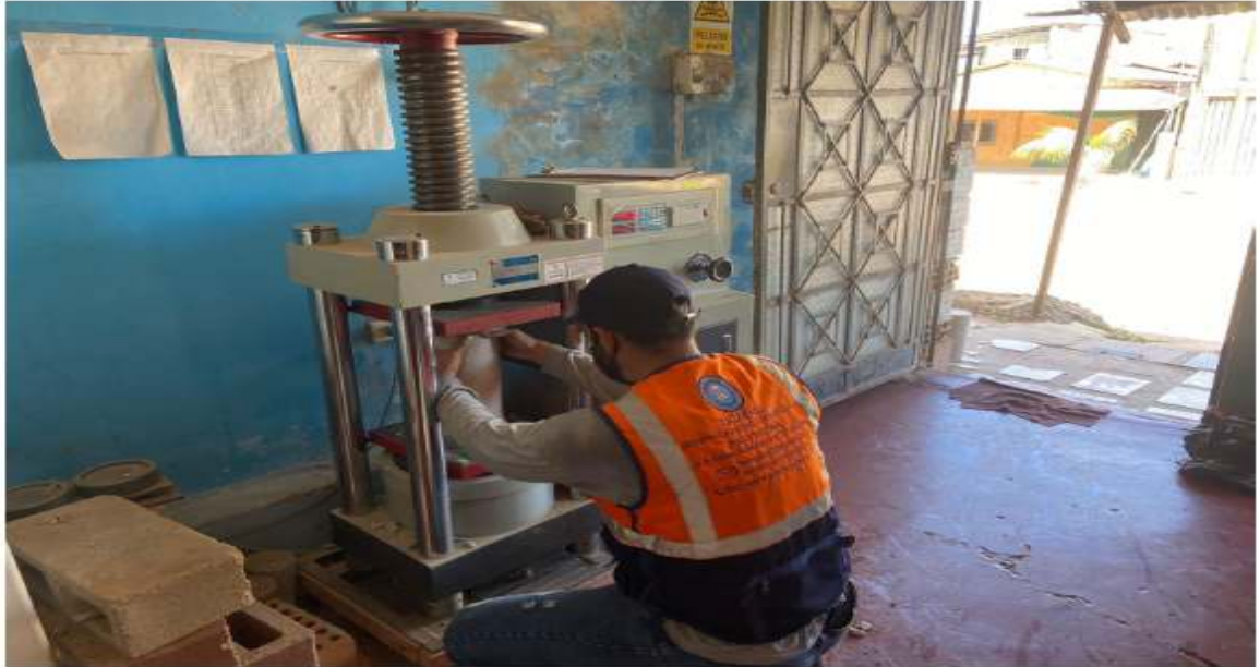
FOTO N°01: SE OBSERVA AL PERSONAL TECNICO INICIANDO CON EL ENSAYO DE RESISTENCIA A LA COMPRESION (7 DIAS).
