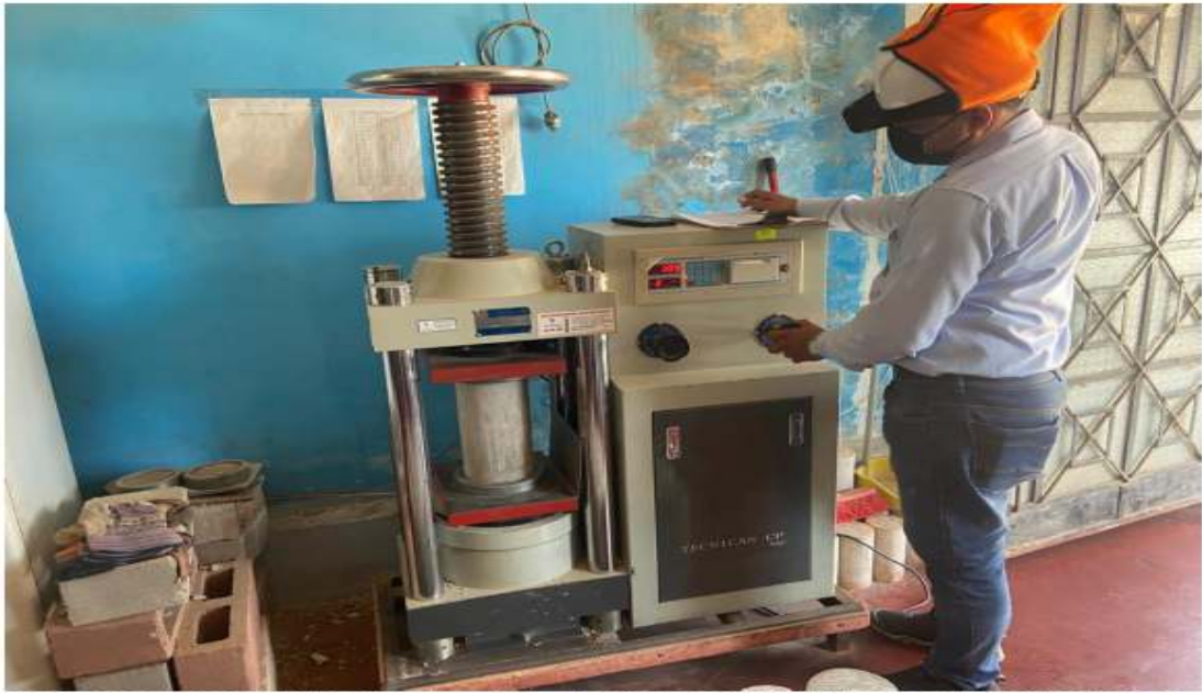
FOTO N°05: SE OBSERVA AL PERSONAL TECNICO CONTINUANDO CON EL ENSAYO DE RESISTENCIA A LA COMPRESION (14 DIAS)
