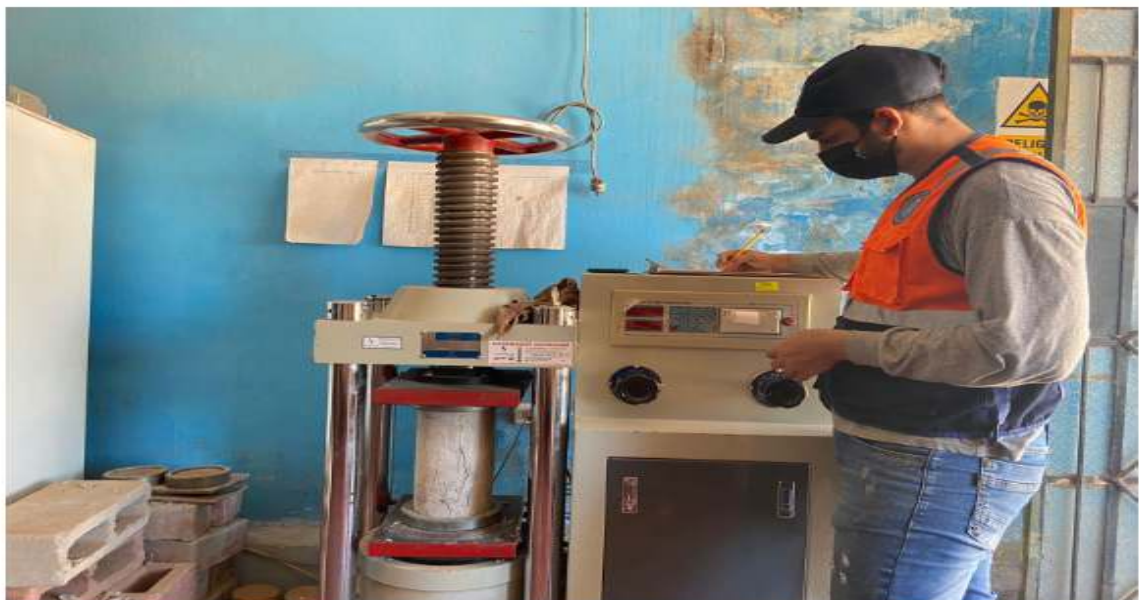
FOTO N°02: SE OBSERVA AL PERSONAL TECNICO CONTINUANDO CON EL ENSAYO DE RESISTENCIA A LA COMPRESION (7 DIAS).
