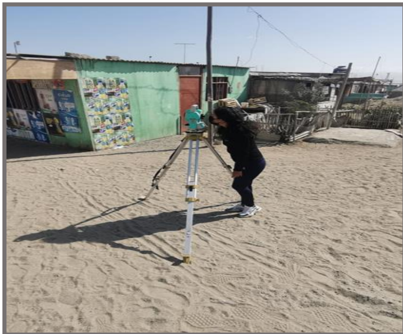
Figura N°04: Estación total en la av. industrial
