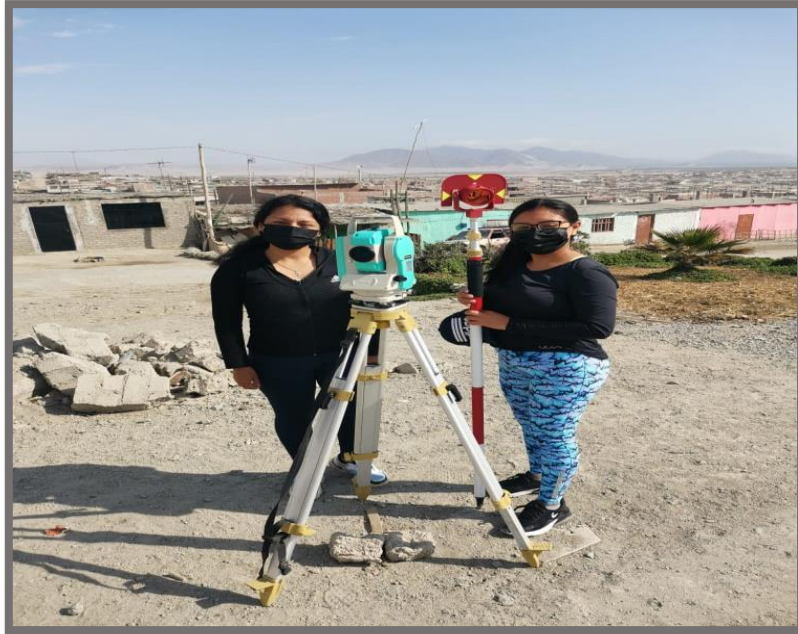
Figura N°03: Estación total sobre reservorio proyectado.
