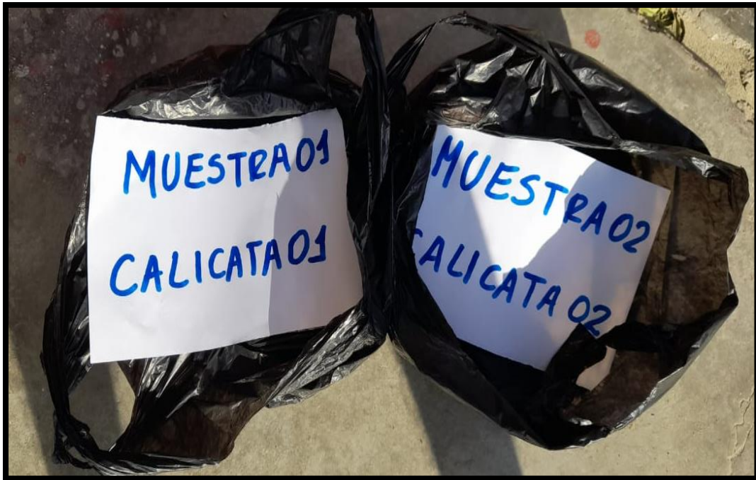
Toma de muestras del suelo de la calicata N°01 y N°02 para llevarlas al laboratorio de suelos.
