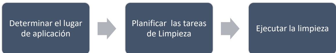
Figura 12. Fases de implementación de la tercera S – Seiso / Limpieza
