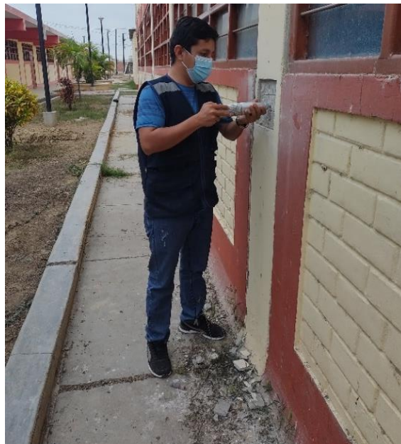
Figura 17. Utilización de esclerómetro en columna C-2
