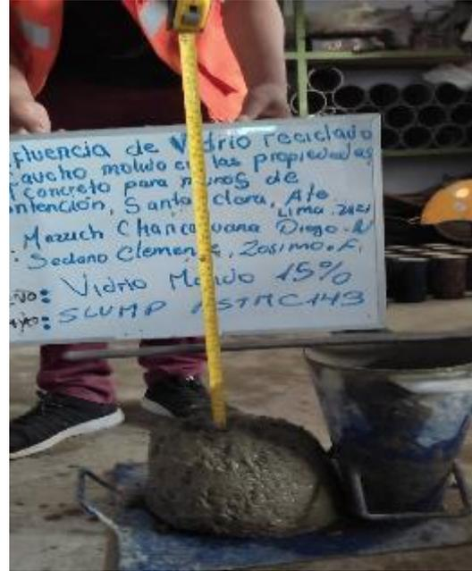
Figura 31. Ensayo de asentamiento de slump de vidrio molido.
