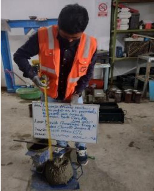
Figura 30. Ensayo de asentamiento de slump de caucho molido
