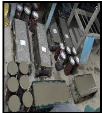
Imagen 8. Temperatura, slump y los especímenes terminados con adiciones de vidrio y caucho molido.
