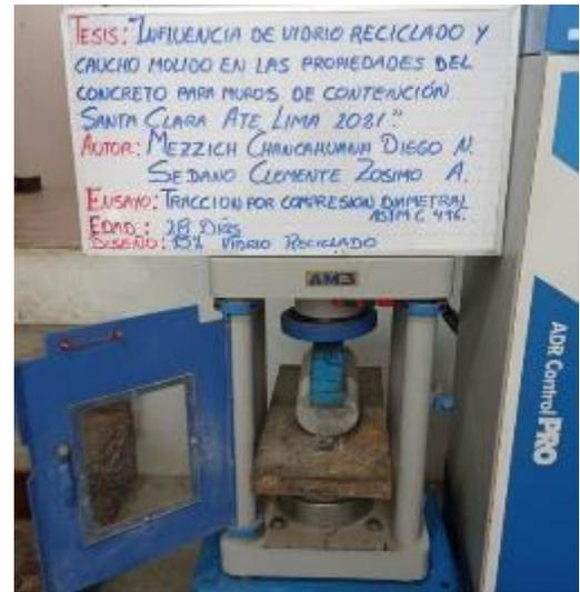
Figura 22. Ensayo de resistencia de tracción diametral (10% caucho molido).
