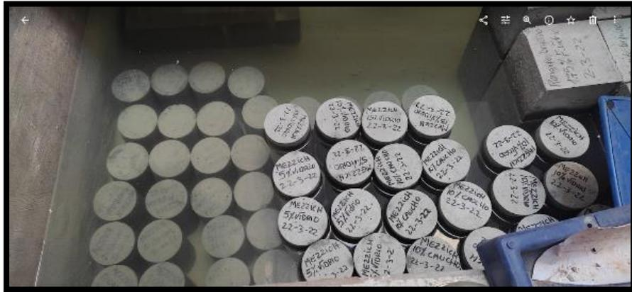
Imagen 9. especímenes terminados y en proceso de curación con adiciones de vidrio y caucho molido.
