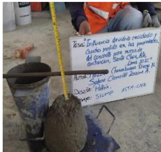
Figura 32. Ensayo de asentamiento de slump Del concreto patrón.
