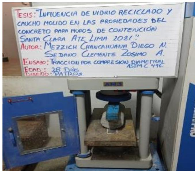
Figura 24. Ensayo de resistencia por tracción diametral del concreto patrón (28 días).
