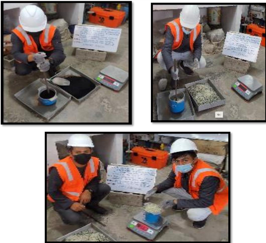
Imagen 6. Ensayos de peso unitario de vidrio y caucho molido.
