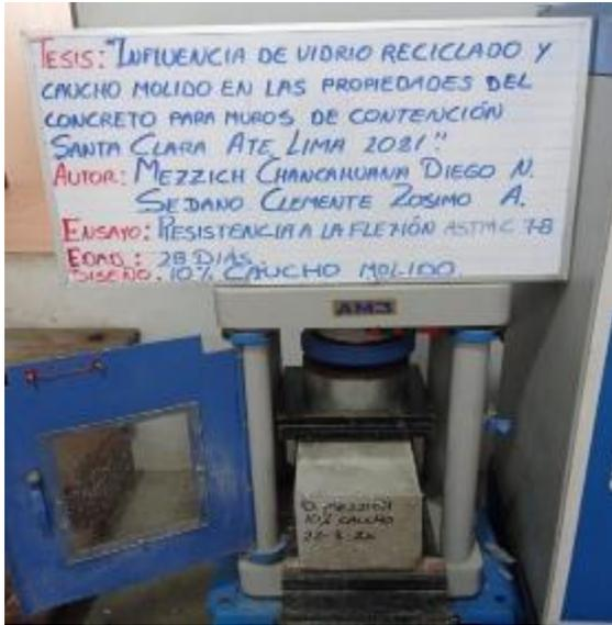
Figura 26. Ensayo de resistencia de flexión (10% de caucho molido).
