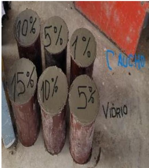
Figura 19. Moldes 4x8" adicionando en Porcentajes de vidrio y caucho molido
