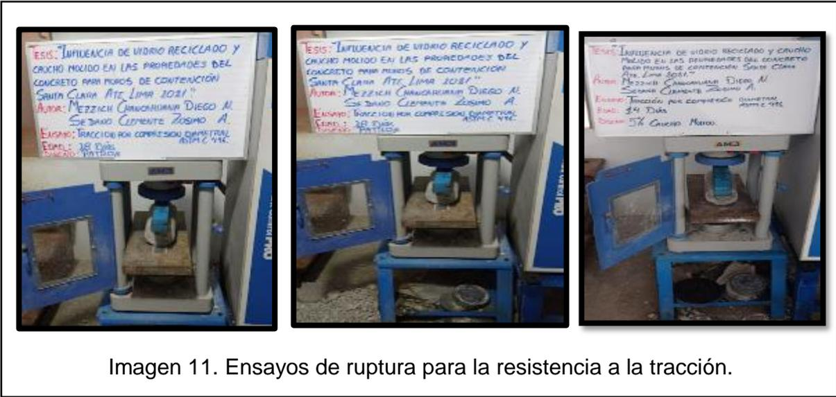
Imagen 11. Ensayos de ruptura para la resistencia a la tracción.
