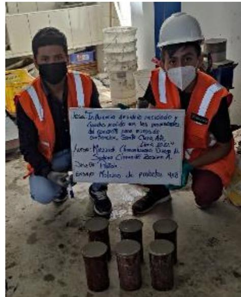
Figura 20. Moldes de probetas 4x8" del diseño del patrón.
