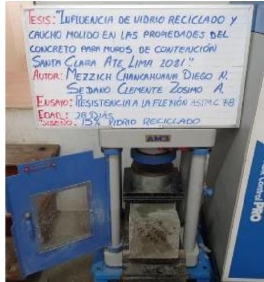
Figura 27. Ensayo de resistencia de flexión (15% de vidrio molido)
