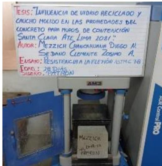
Figura 28. Ensayo de resistencia de flexión (concreto patrón a los 28 días)
