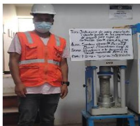
Figura 18. Ensayo de la resistencia a la compresión adicionando el VM.
